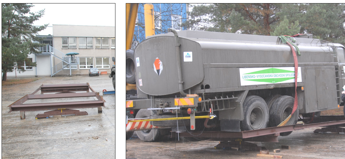
Obr. 26: Měření momentu setrvačnosti vozu T 148 principem odvalovacího kyvadla v areálu Univerzity Pardubice [53]
