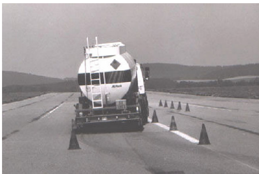
Obr. 29: Průjezd cisternové jízdní soupravy zkušebním koridorem dle metodiky ZM – A/ 07.40 [35]
