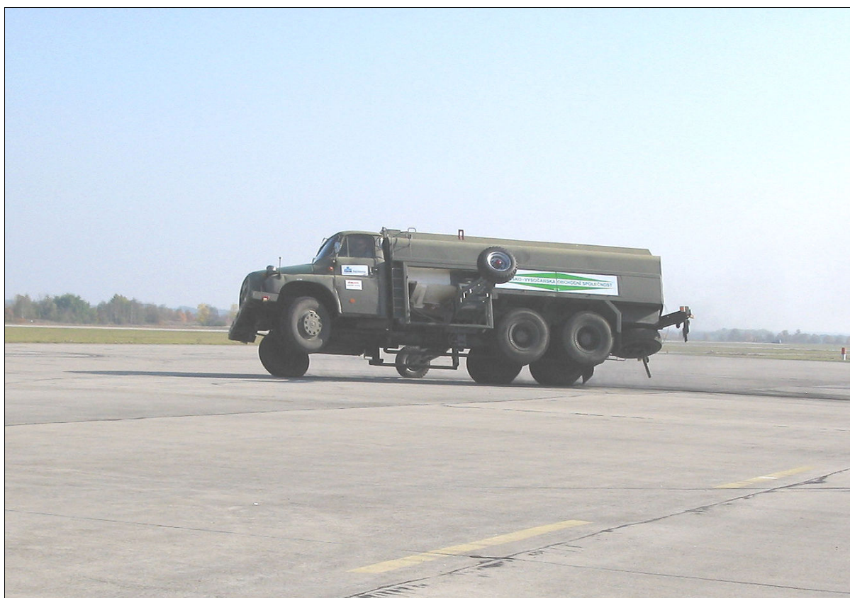
Příloha č. 9: Jízdní zkouška stability cisternového vozidla T 148 [50]
