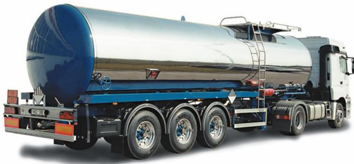
Obr. 1: Jízdní souprava s cisternovým návěsem CN 33N [28]
