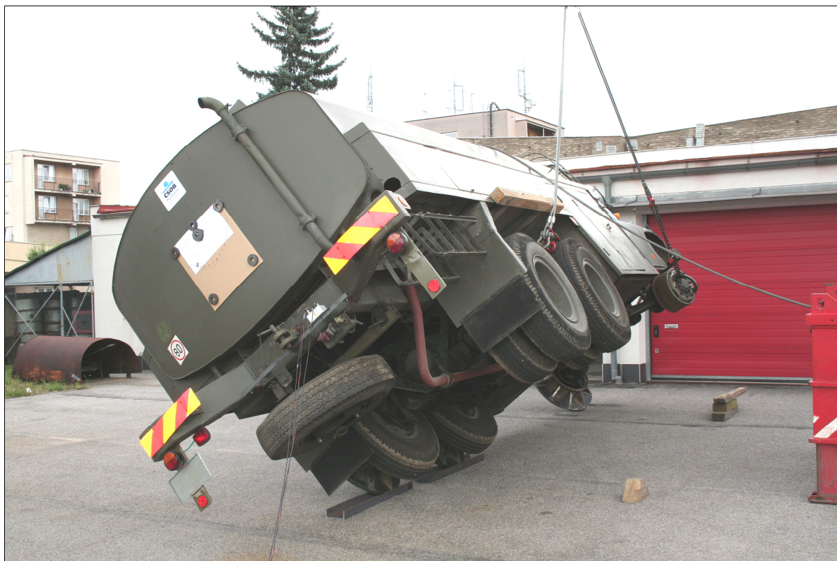
Příloha č. 8: Zjišťování výškové polohy těžiště vozu jeho příčným naklápěním [50]
