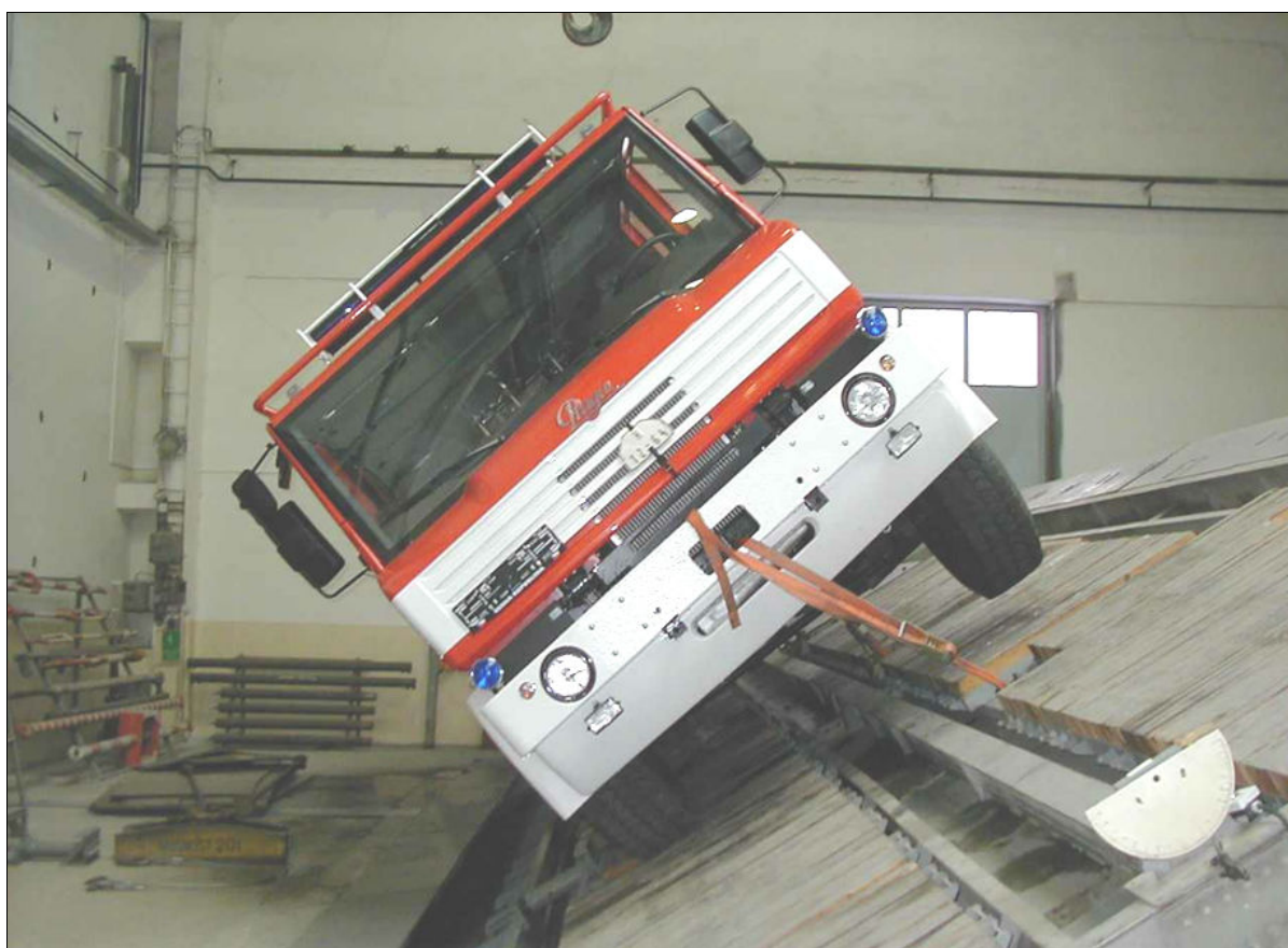
Příloha č. 7: Zkouška stability hasičského vozu na sklopné plošině [50]
