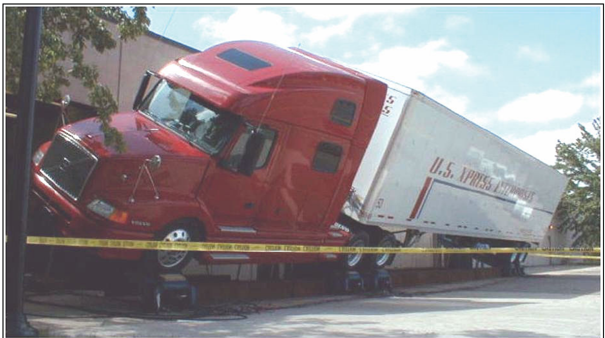
Obr. 6: Zkoušení jízdní soupravy na sklopné plošině dle předpisu EHK č. 111 [55]
