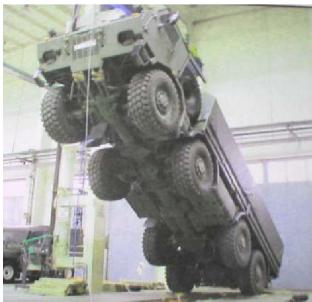
Obr. 24: Zjišťování výškové polohy těžiště vozu jeho podélným naklápěním [54]
