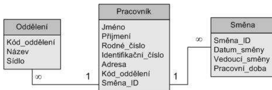
Obrázek 6: Schéma relačního databázového modelu (zdroj: vlastní - zpracováno podle [8])
