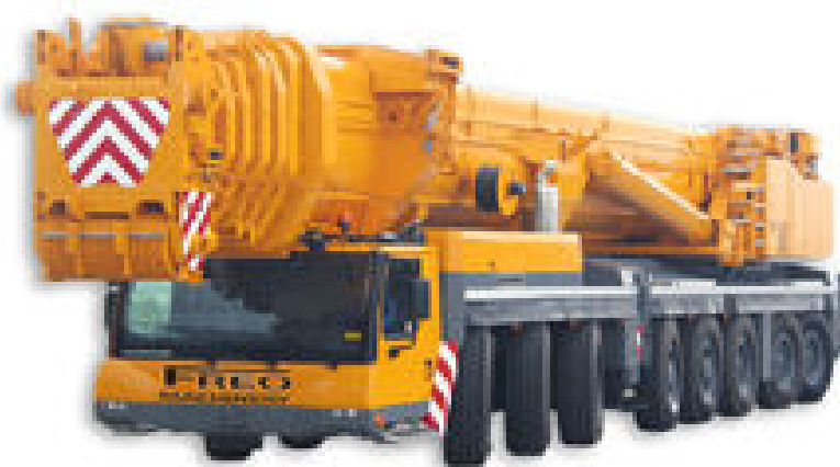
Obr.3.4: Liebherr LTM1500-8.1 500T (16x10x14) - řízení 14WS [17]
