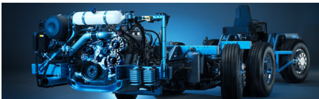
Obr.3.6: Podvozek autobusu Scania s přední i zadní říditelnou nápravou [19]
