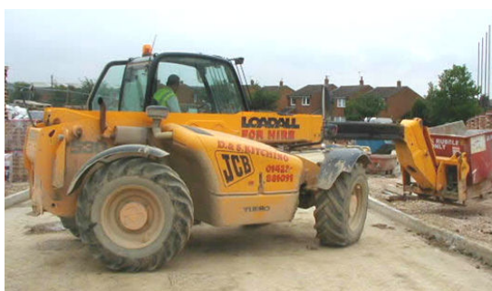
Obr.3.3: JCB 530-70 4WS a možnosti režimů řízení [16]
