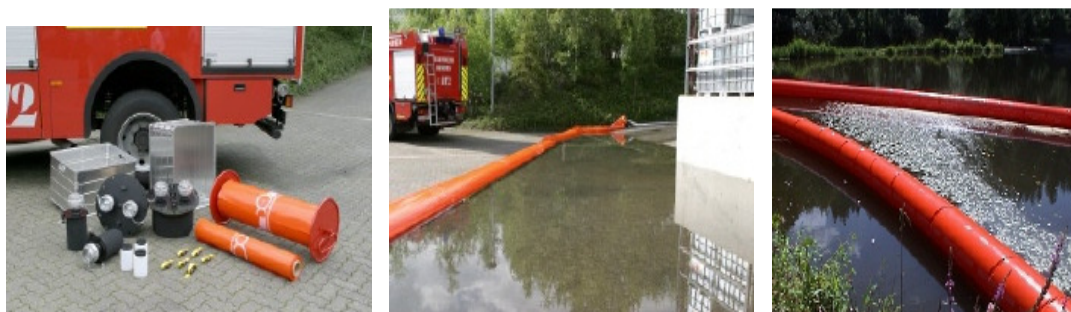
Obrázek č. 16 – Norné stěny
