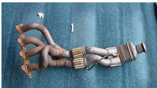
Obr. 131 Původní výfukové svody
