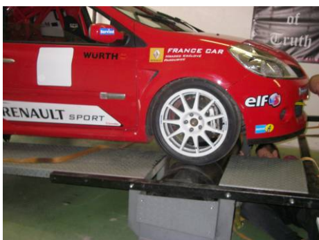
Obr. 194 Upevnění na válcové zkušebně
