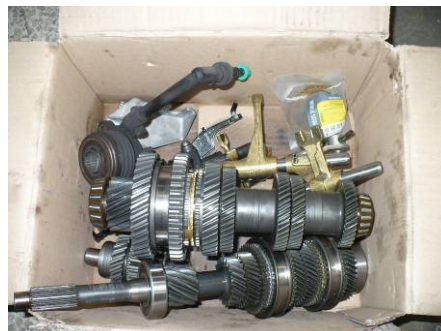
Obr. 159 Demontované hřídele převodovky
