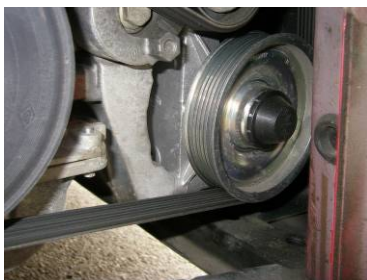
Obr. 14 Řemenice po instalaci
