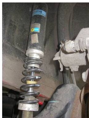
Obr. 99 Nainstalované zadní tlumiče
