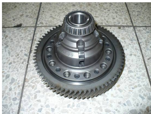
Obr.162 Lamelový samosvorný diferenciál Clio
