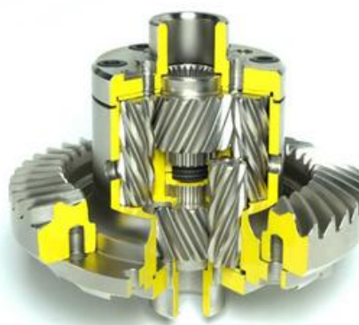
Obr. 161 Samosvorný diferenciál typu Torsen [12]
