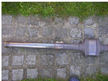
Obr. 133 Původní středový díl s katalyzátorem
