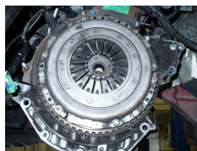
Obr. 148 Nainstalovaná spojková sada
