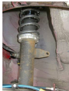
Obr. 100 Nainstalované zadní tlumiče
