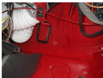
Obr. 185 Odvětrání čelního okna
