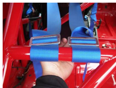
Obr. 67 Připevnění pásů na ochrannou konstrukci [4] Obr. 68 Připevnění pásů na ochrannou konstrukci Clio
