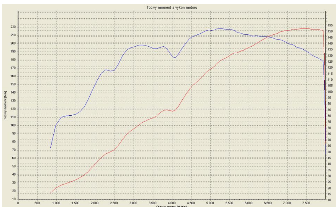
Graf 1 Průběh výkonu a točivého momentu
