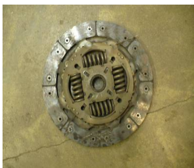
Obr. 145 Třecí kotouč opotřebený
