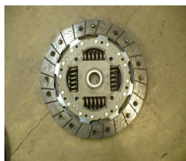
Obr. 146 Třecí kotouč nový originál
