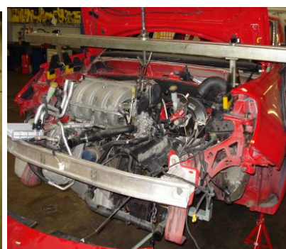
Obr. 156, 157 Přípravek pro upnutí motoru
