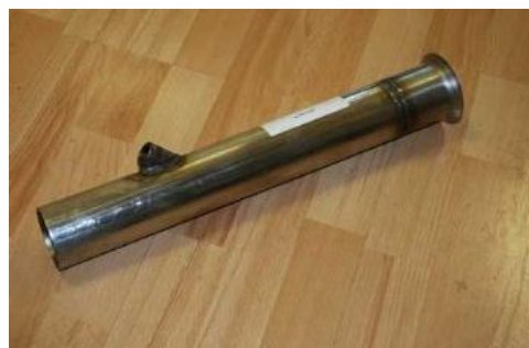
Obr. 134 Nový středový díl bez katalyzátoru
