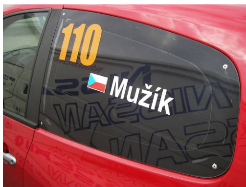
Obr. 167 Boční polykarbonátová okna
