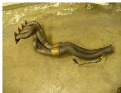
Obr. 132 Upravené výfukové svody
