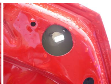
Obr. 170 Povrchová ochrana otvorů
