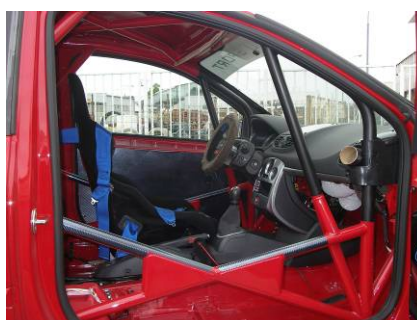
Obr. 49 Zesílení konstrukce dveří Clio
