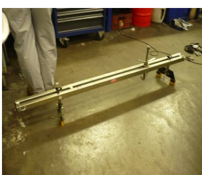
Obr. 156, 157 Přípravek pro upnutí motoru
