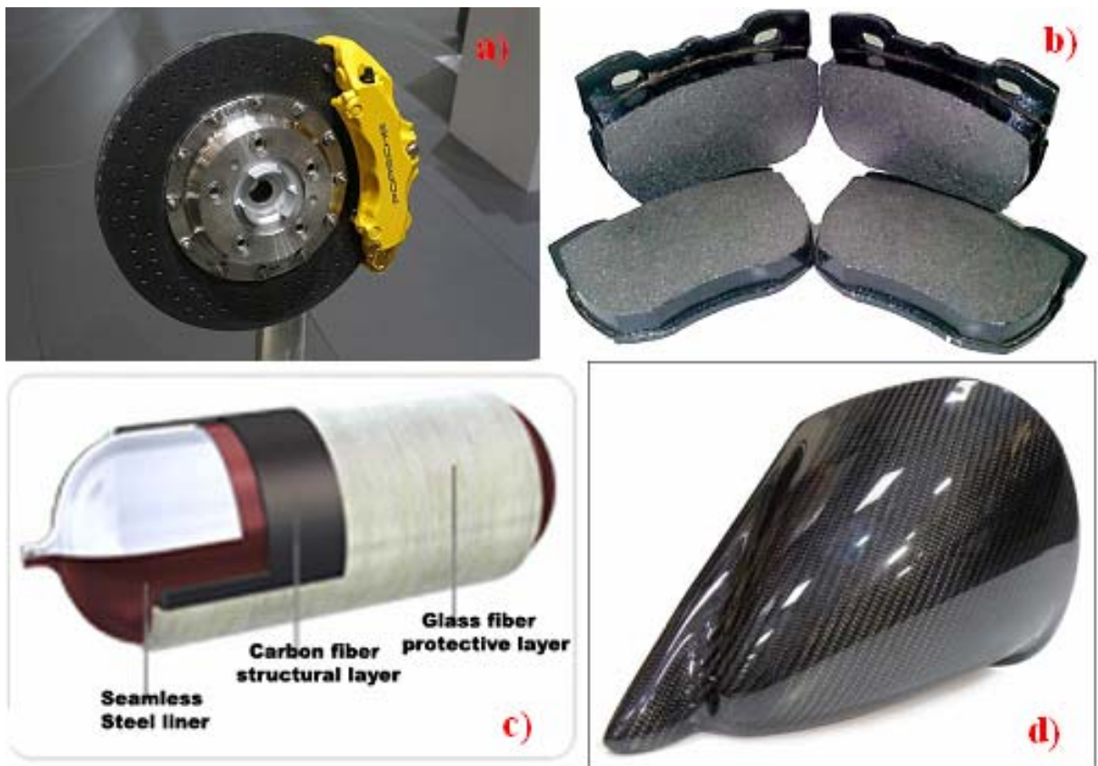
Obr. 6 Příklady kompozitních částí automobilu a) brzdový kotouč [19], b) brzdové segmenty [3], c) nádrž na CNG [18], d) zpětné zrcátko [15]
