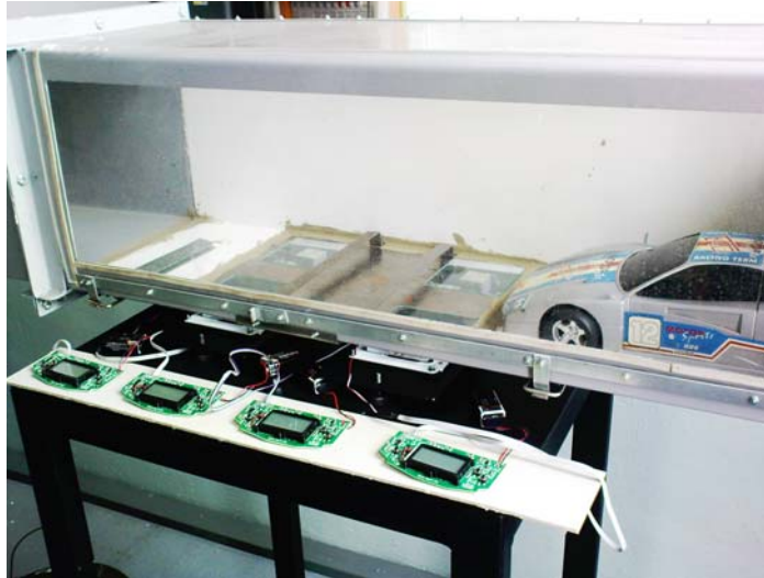
Obr. 12 Vyvedení displejů před tunel
