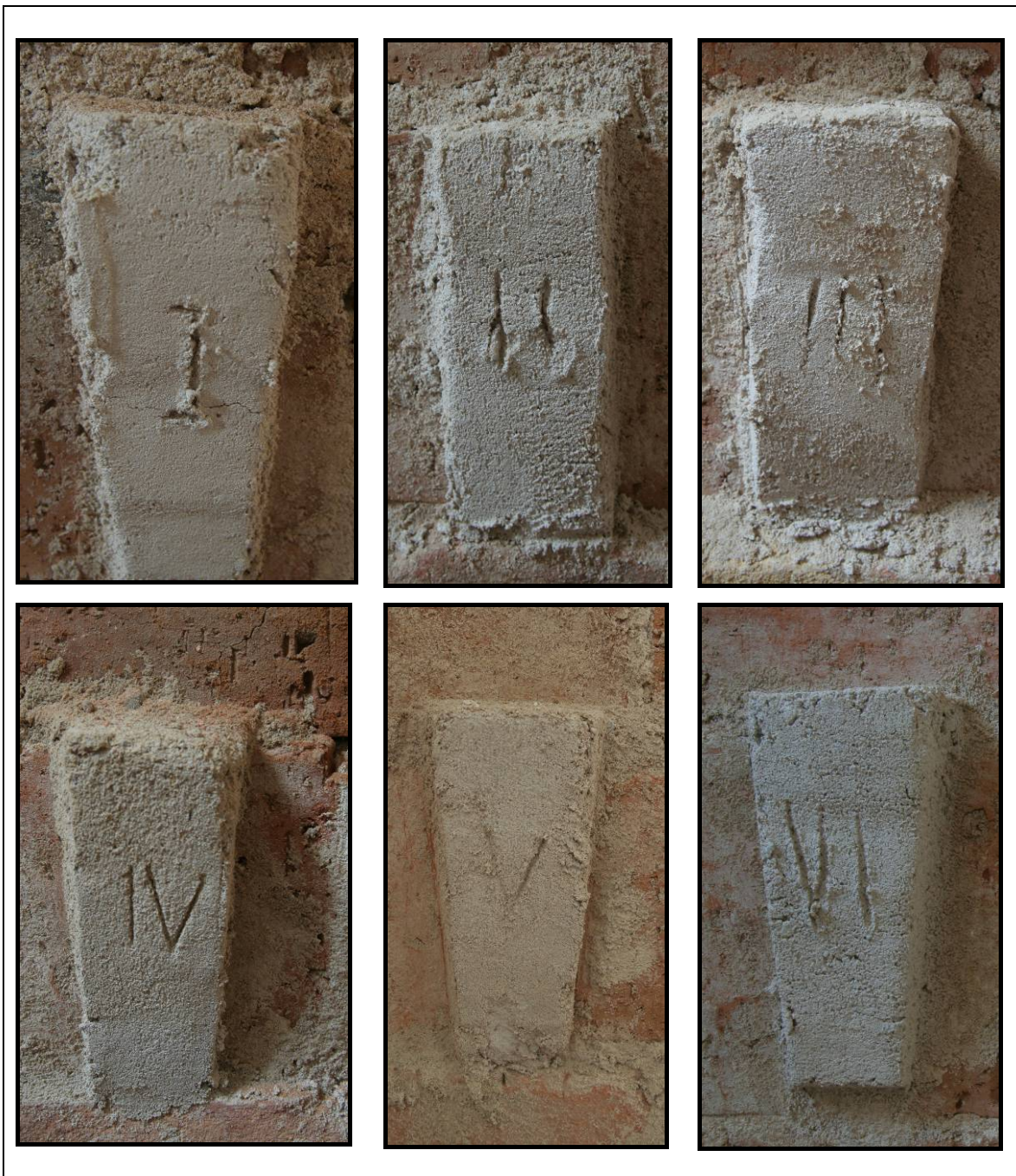
Obr. 21 Stav klínů po šesti měsících tvrdnutí
