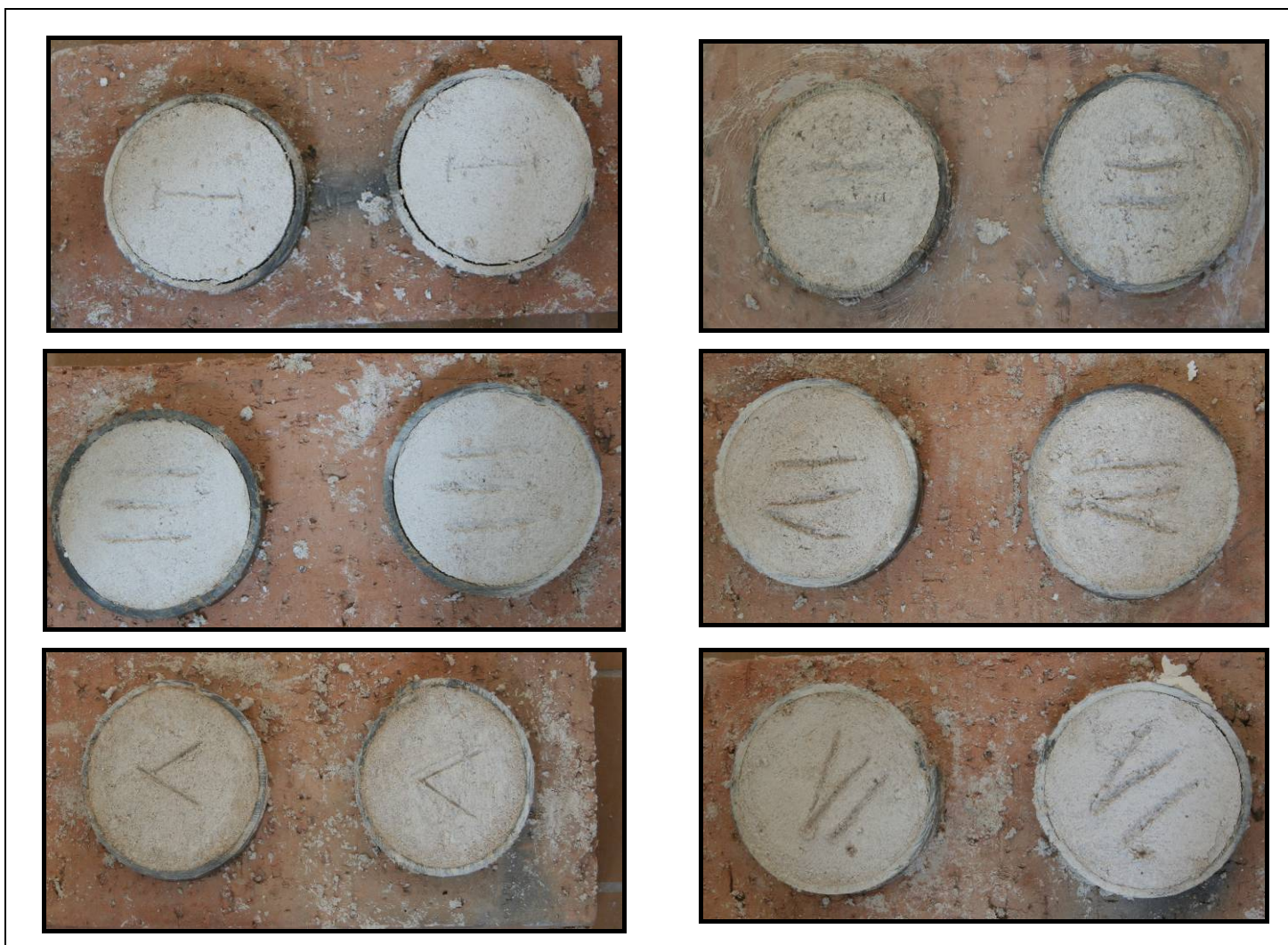
Obr. 17 Maltové koláče po třech měsících tvrdnutí (savý podklad I, III, IV, V, VI)
