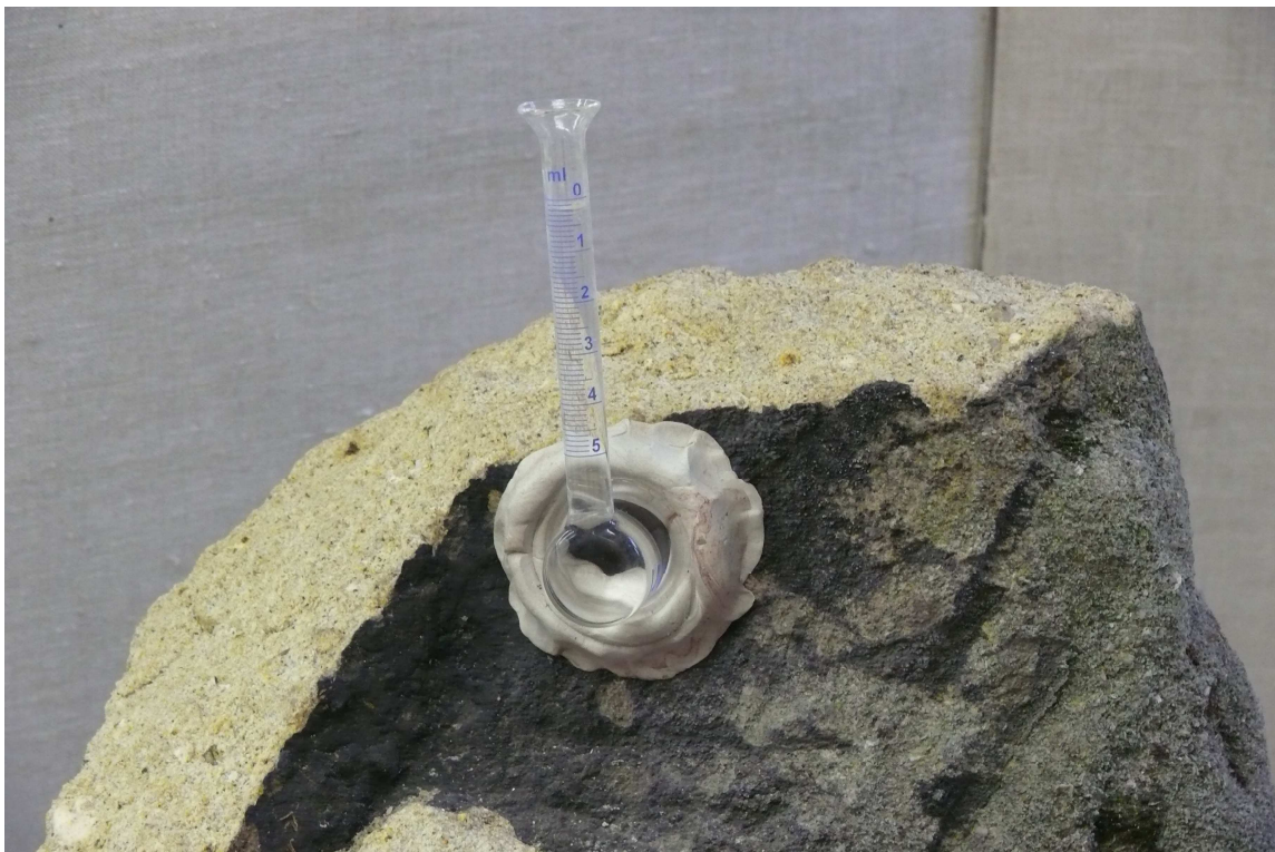
Obr. 12 – zkoušky nasákavosti na kameni pokrytém krustou
