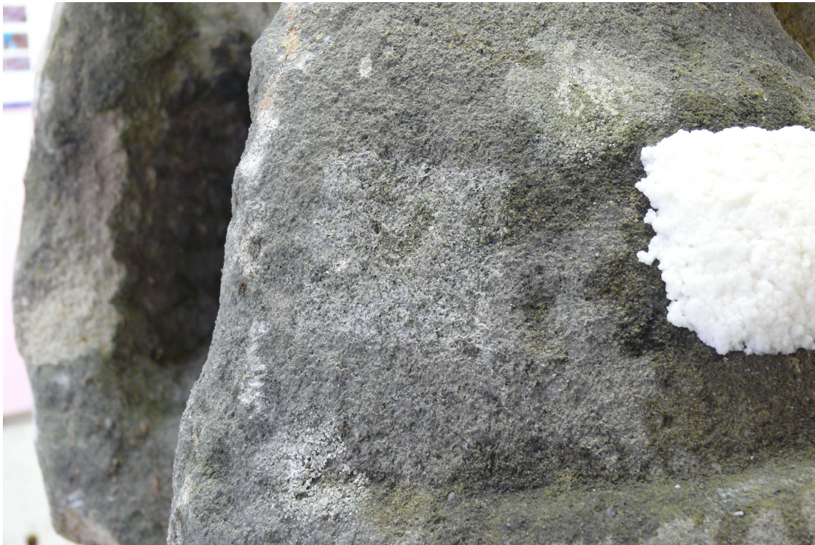
Obr. 12 – zkoušky nasákavosti na kameni pokrytém krustou
