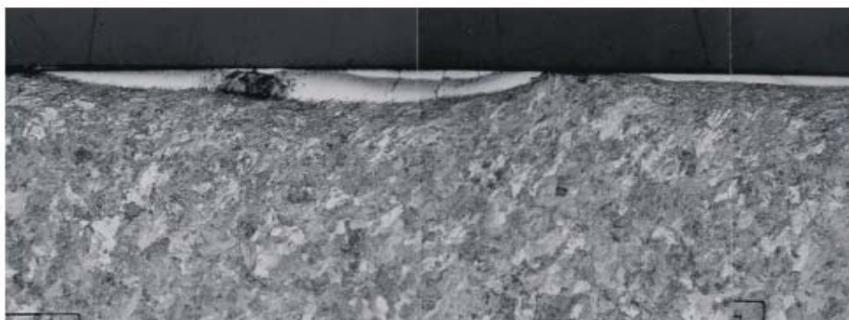
Obr. 1 Bíle naleptaná vrstva (WEL) na povrchu železniční kolejnice [2]. NITAL, zv. 100x.
