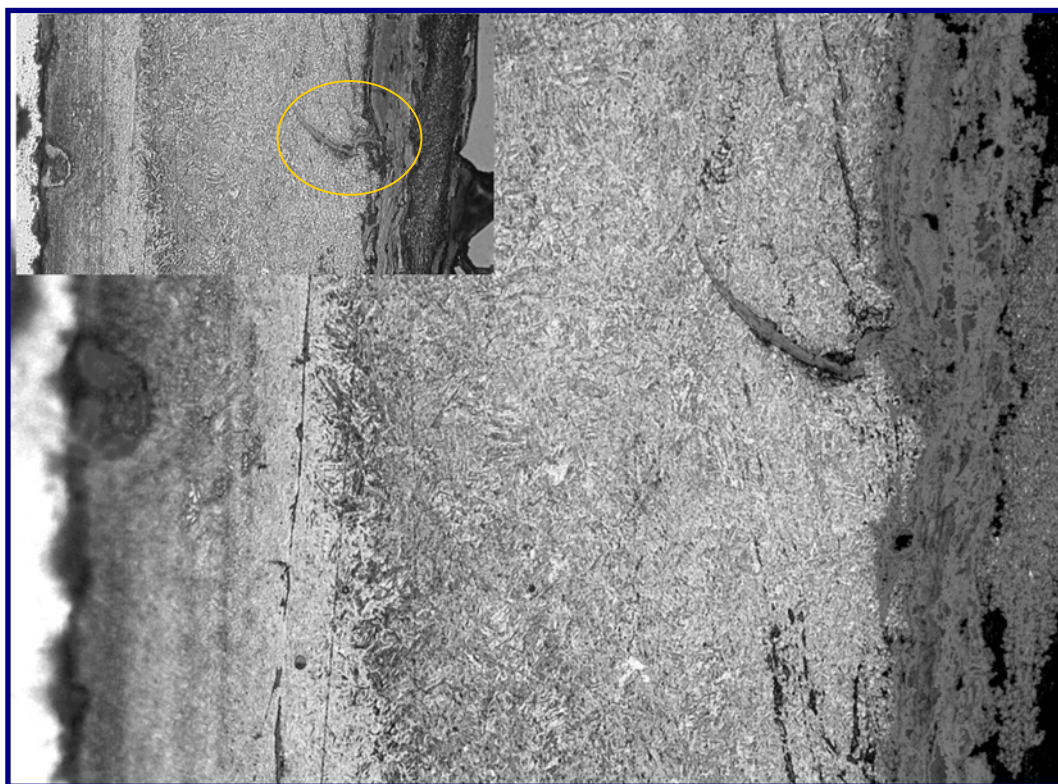
Obr. 2 Mikrostruktura studované štěpiny po popouštění 250°C/4hod. Leptáno-NITAL, zv.250x, resp. 50x.
