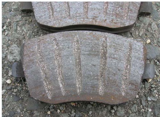
Obr. 4: Pohled na vybroušené příčné drážky v brzdových destičkách
