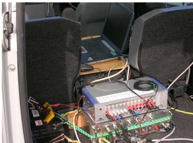
Obr.5: Měřící ústředna a notebook uvnitř vozu
