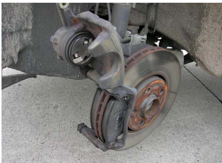
Obr. 8: Výměna upravených brzdových destiček před jízdami brzdými zkouškami
