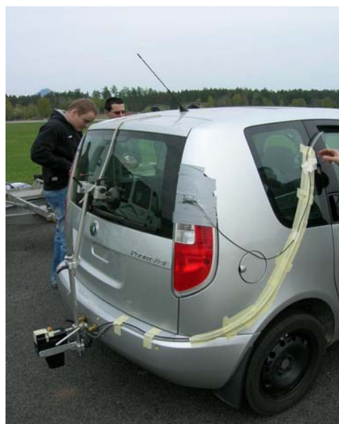
Obr. 7: Pohled na připravený měřicí aparát na vozidle
