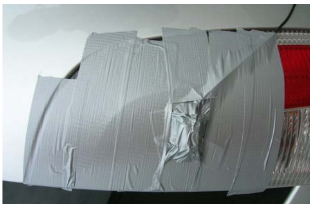
Obr.6: Upevněný světelný snímač brzdového světla
