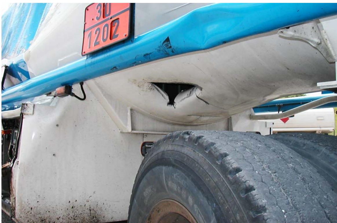
Obrázek 4: Průraz první komory cisternového návěsu
