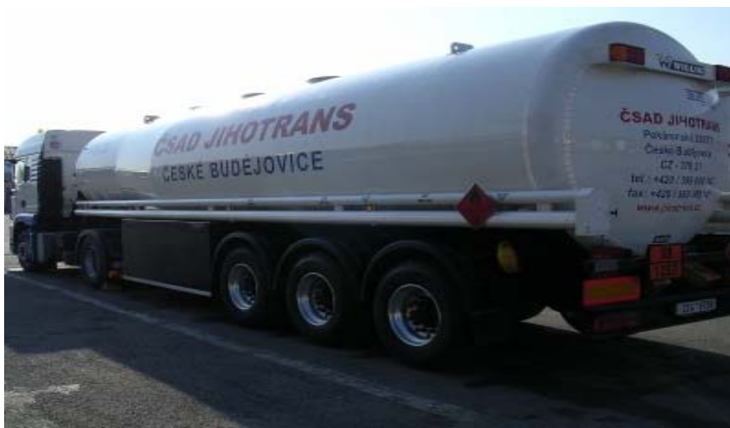
Obrázek 2: Cisternový návěs WILLIG s válcovo-konickým tvarem
