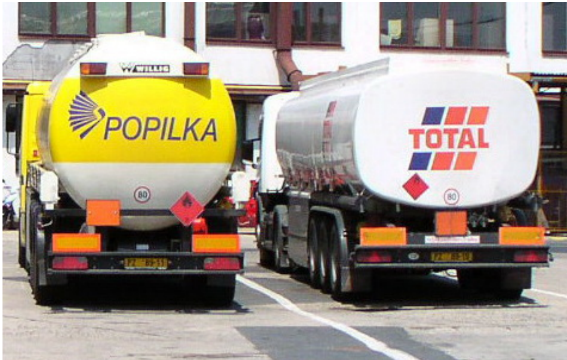
Obrázek 3: Porovnání výšky těžiště pouhým okem
