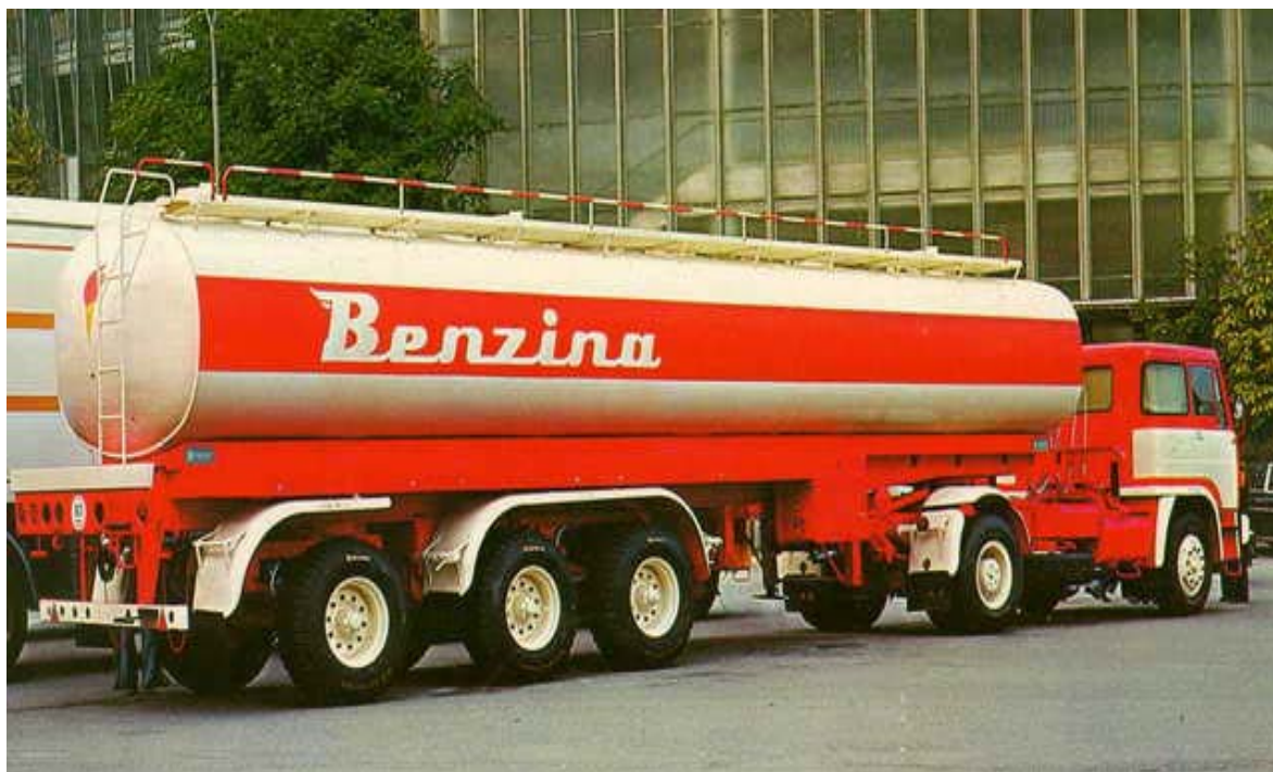
Obrázek 1: Souprava cisternového tahače LIAZ s návěsem CN 35
