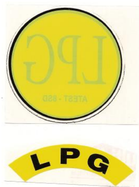
Obrázek č. 5.: Samolepky označující vozidlo přestavěné na LPG.
