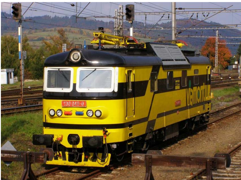
← lokomotiva 130.049 VIAMONT s novými návěstními světly na bázi LED [2]
