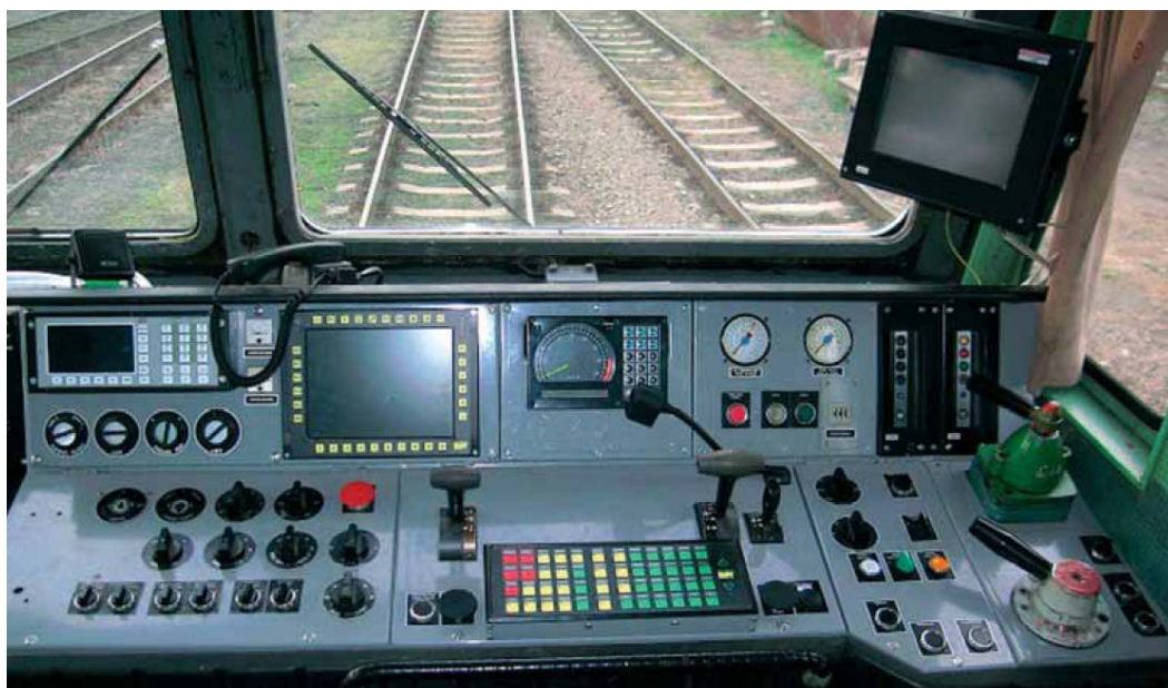
↑ stanoviště lokomotivy 362.166 ČD vybavené palubní částí GSM-R a ETCS [4]
