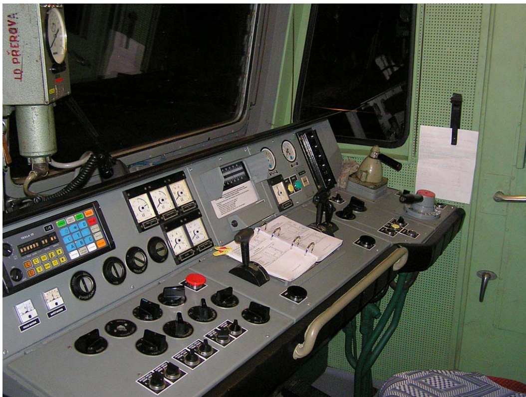
↑ stanoviště lokomotivy 363.032 ČD Cargo vybavené komunikačním systémem TRS a vlakovým zabezpečovačem LS [3]
