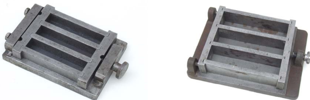
Obrázek 2: Formy pro přípravu zkušebních hranolů s rozměry 20x20x100 mm a 40x40x160 mm.
