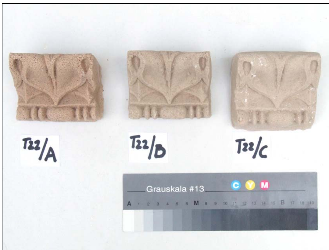
Obrázek 22: Konzolky zhotovené ze směsí T22/A, T22/B, T22/C.
