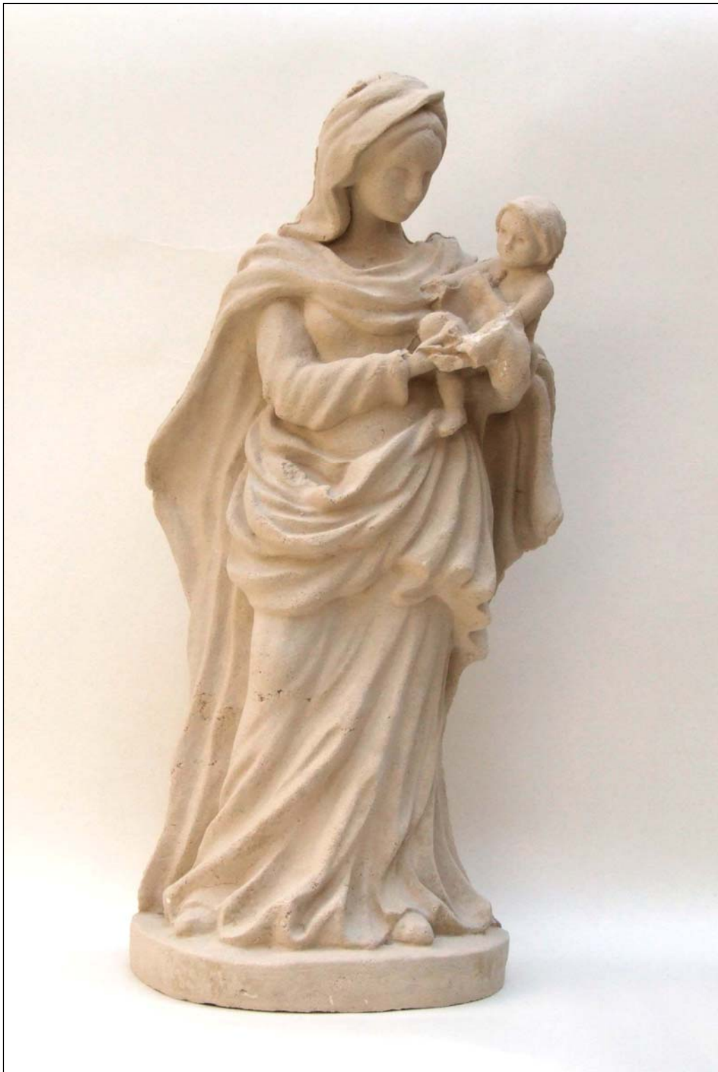
Obrázek 34: Socha zhotovená ze směsi T6/C imitující hořický pískovec.
