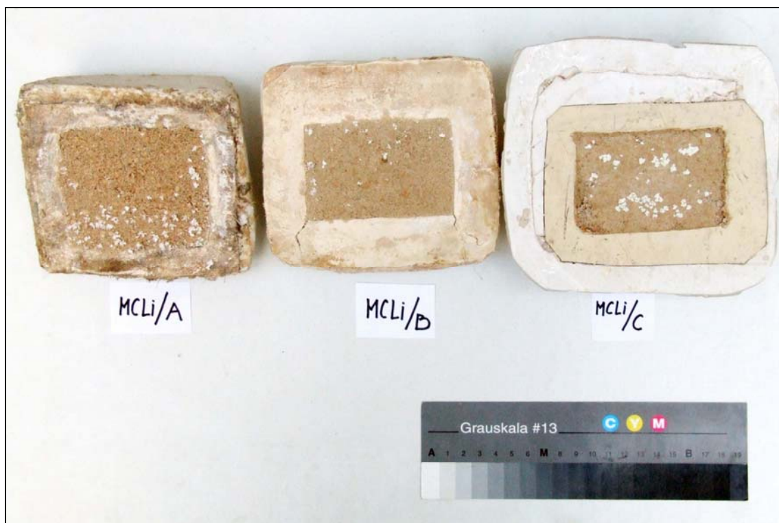
Obrázek 24: Konzolky zhotovené ze směsí MCLi/A, MCLi/B, MCLi/C před odformováním s patrnými výkvěty.
