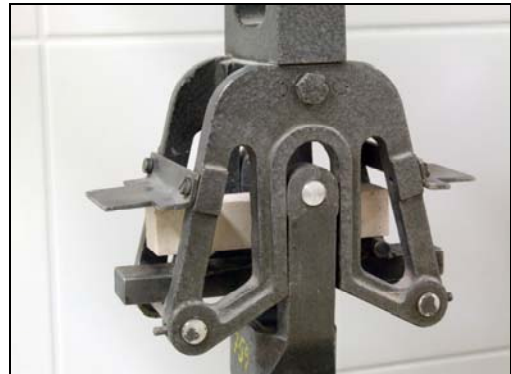
Obrázek 4: Michaelisův přístroj s brokovou zátěží pro stanovení pevnosti v tahu za ohybu, detail.
