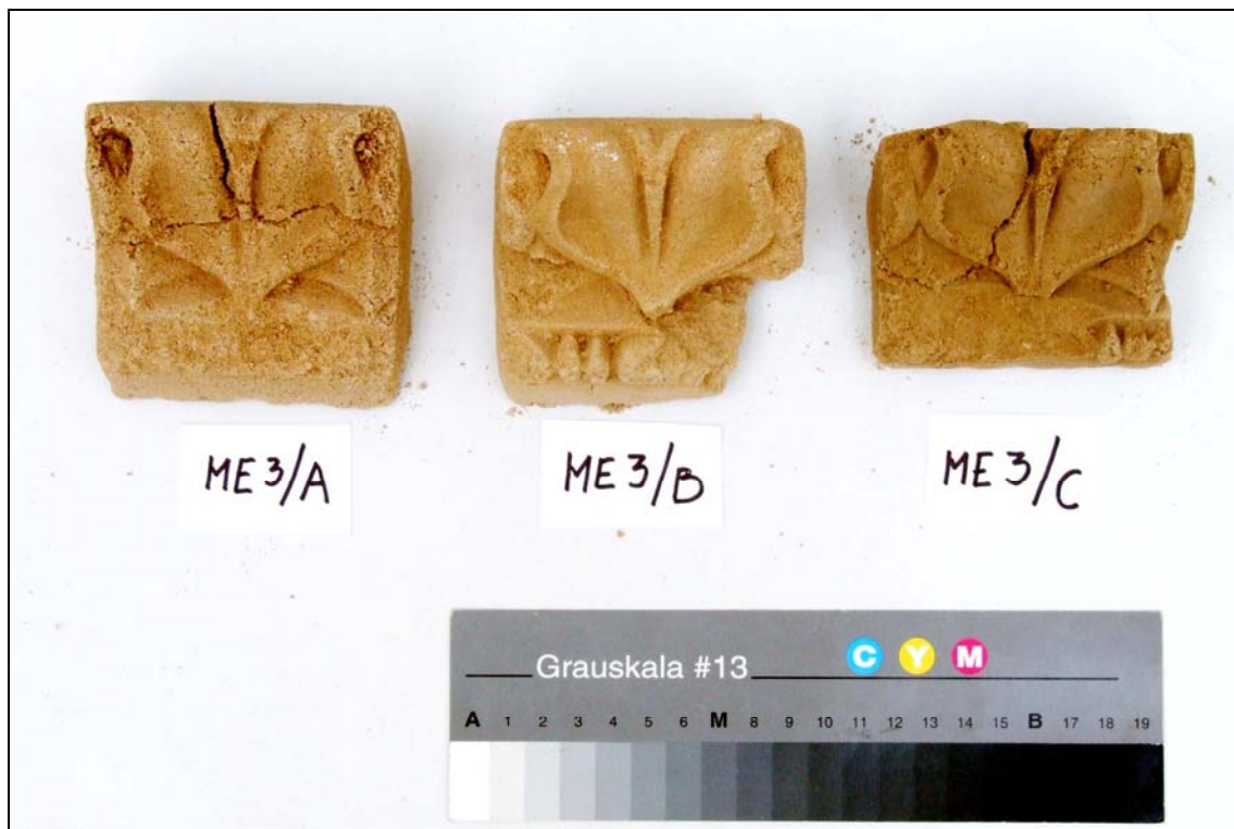
Obrázek 25: Konzolky zhotovené ze směsí ME3/A, ME3/B, ME3/C po neúspěšném odformování.
