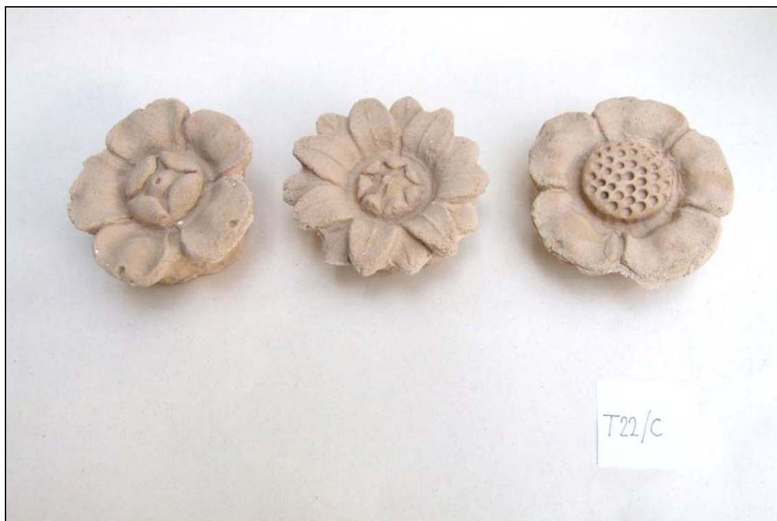
Obrázek 30: Květiny zhotovené ze směsi T22/C imitující hořický pískovec.
