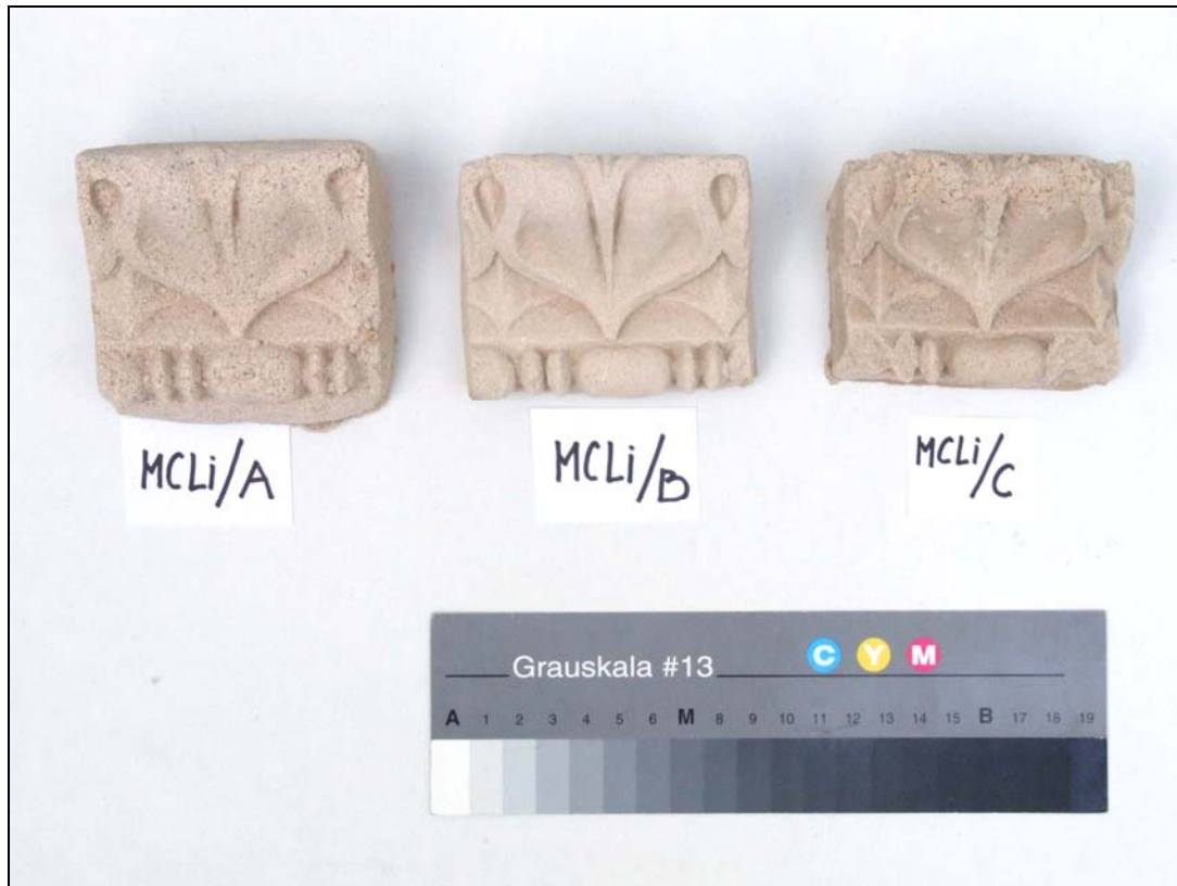
Obrázek 23: Konzolky zhotovené ze směsí MCLi/A, MCLi/B, MCLi/C.
