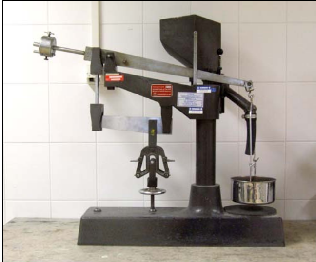
Obrázek 4: Michaelisův přístroj s brokovou zátěží pro stanovení pevnosti v tahu za ohybu, detail.
