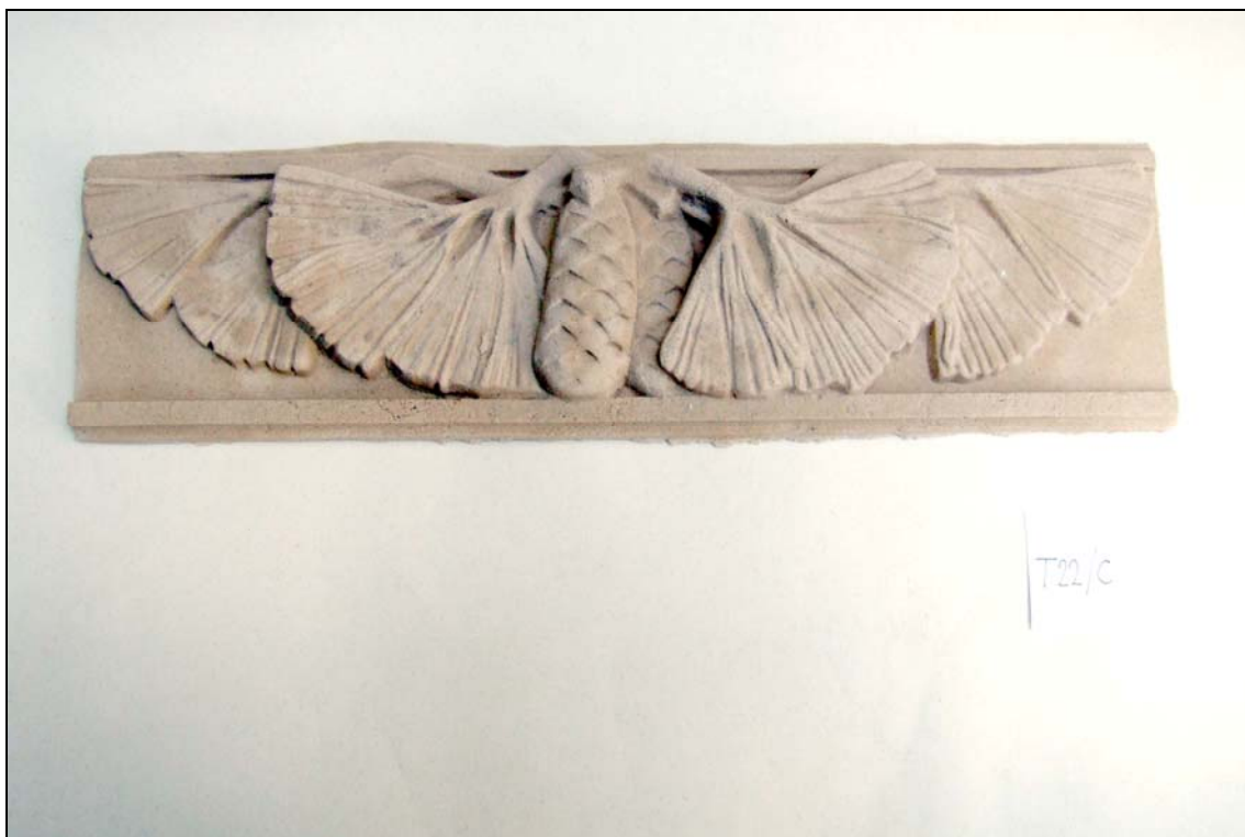
Obrázek 27: Nízký reliéf zhotovený ze směsi T22/C imitující hořícký pískovec.
