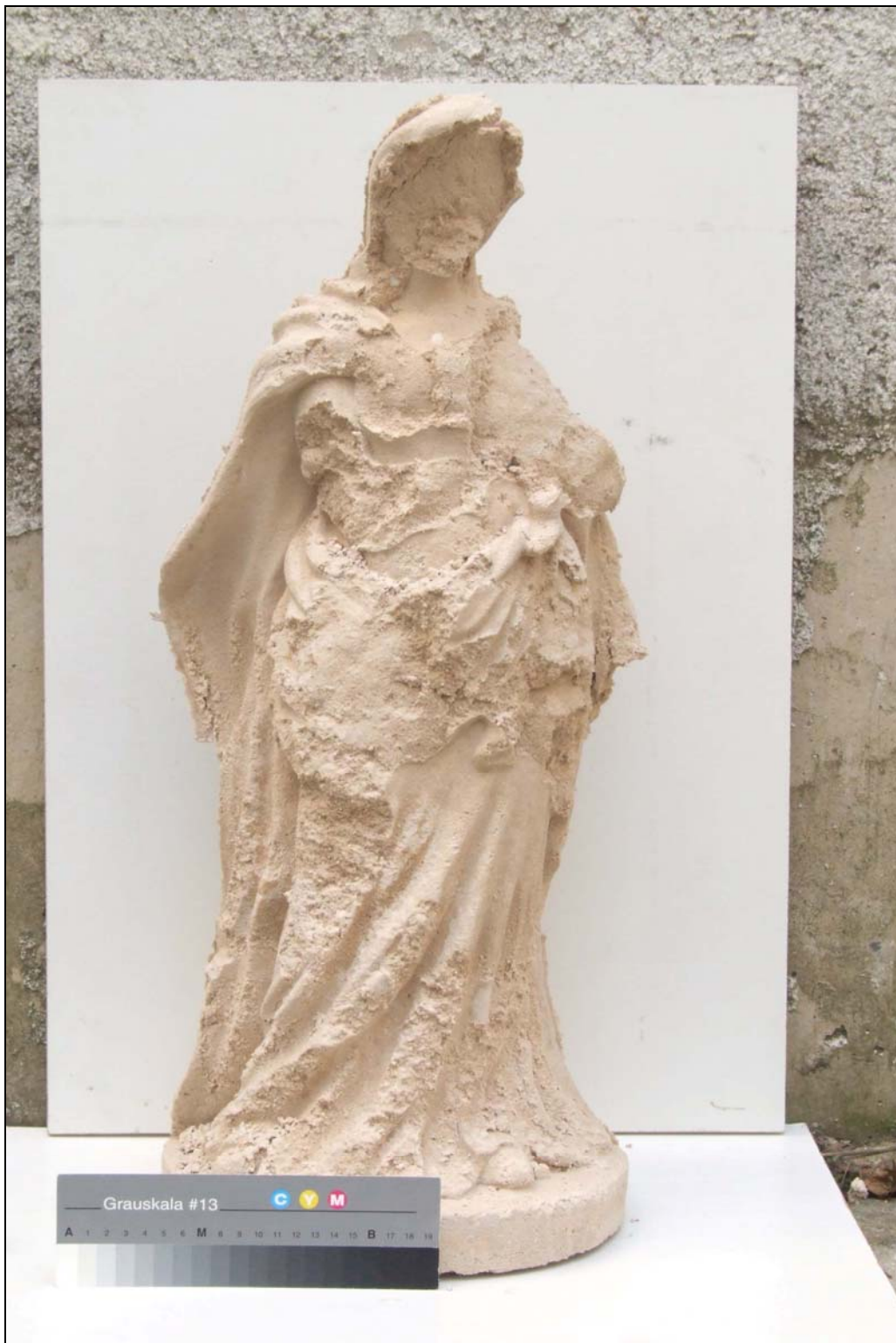
Obrázek 33: Socha zhotovená ze směsi K/B imitující mšenský pískovec po neúspěšném odformování.
