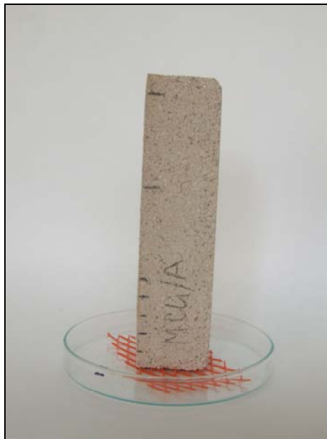
Obrázek 7: Zkušební hranol v Petriho misce připravený pro měření kapilárního vztlínání.
