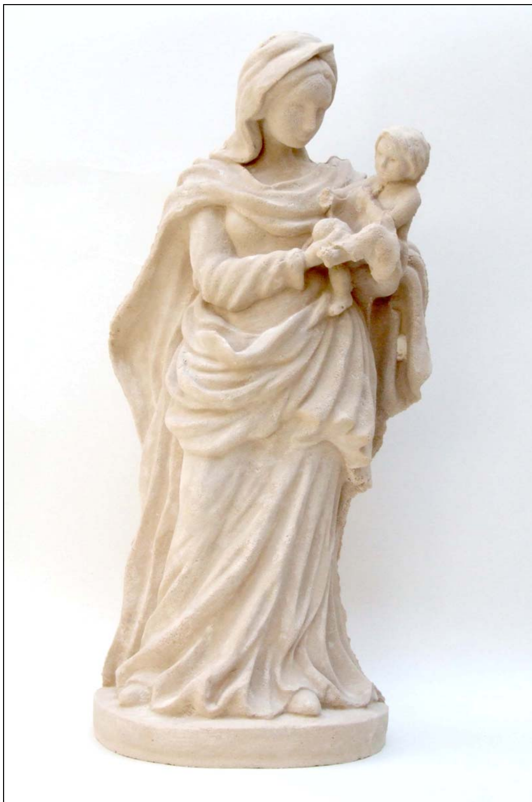
Obrázek 35: Socha zhotovená ze směsi T22/C imitující hořický pískovec.
