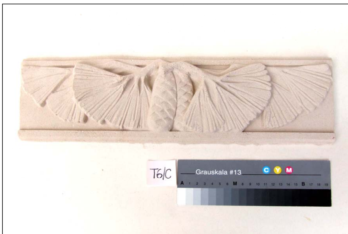
Obrázek 26: Nízký reliéf zhotovený ze směsi T6/C imitující hořický pískovec.
