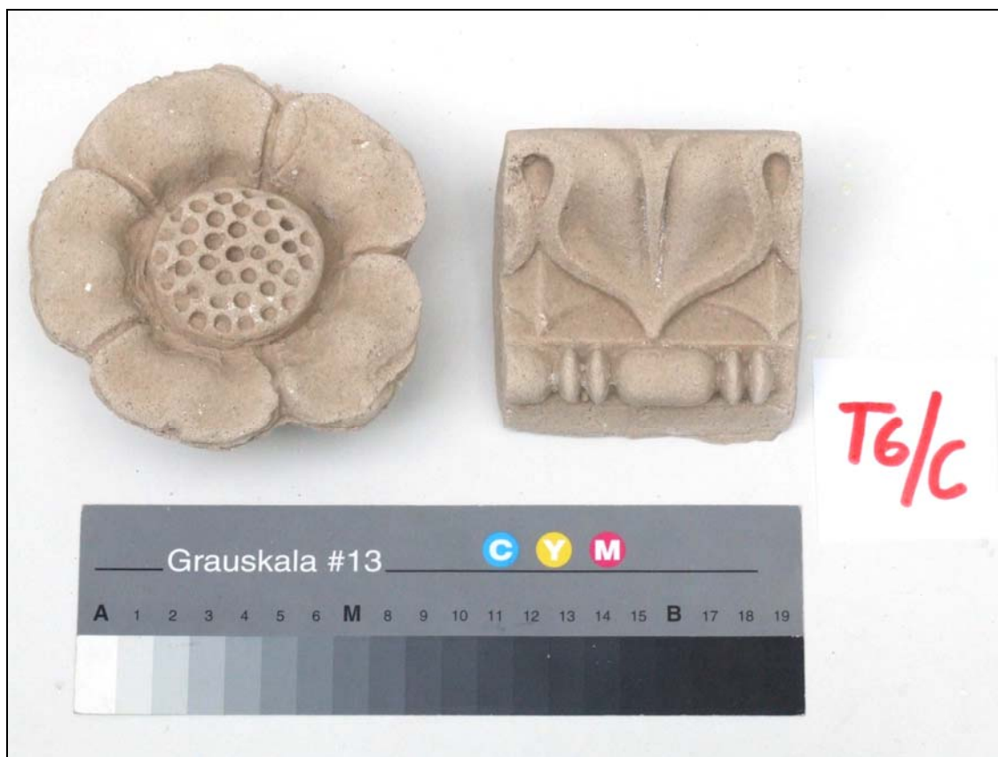
Obrázek 29: Květina a konzolka zhotovené ze směsi T6/C imitující hořický pískovec.
