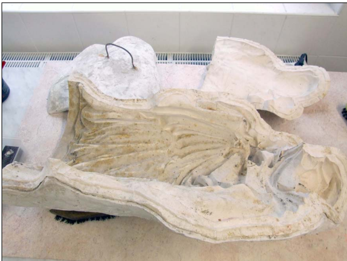
Obrázek 32: Silikonová forma se sádrovým kadlubem pro tvorbu kopie sochy.
