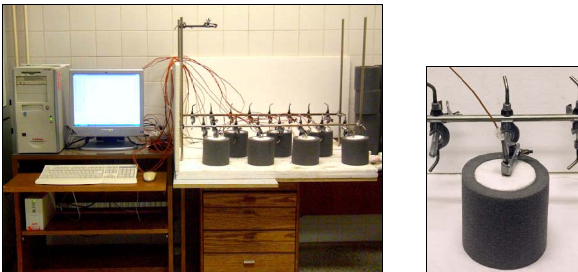
Obrázek 6: Vícemístný isoperibolický kalorimetr, detail termoizolačního obalu.
