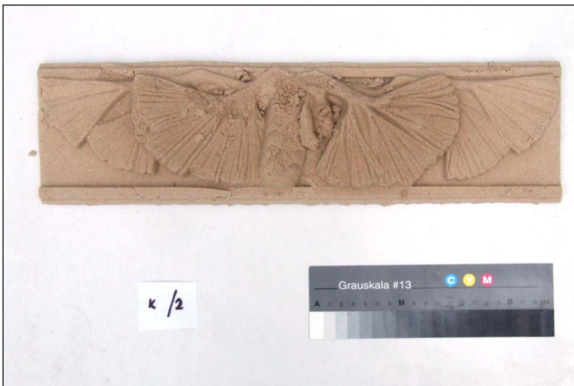
Obrázek 28: Nízký reliéf zhotovený ze směsi K/C imitující hořícký pískovec. Na obrázku jsou dobře patrné defekty vzniklé při odformování.
