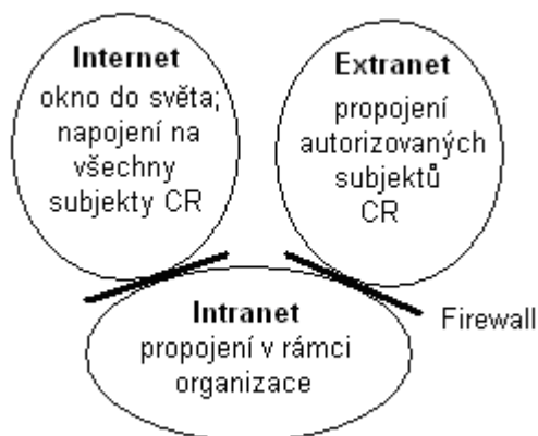
Obr. 4 Propojení počítačových sítí Zdroj: [3]
