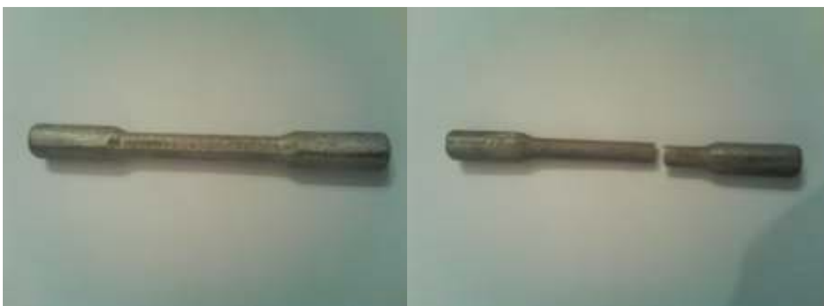
Obr. 17: Zkušební tyč před a po tahové zkoušce
