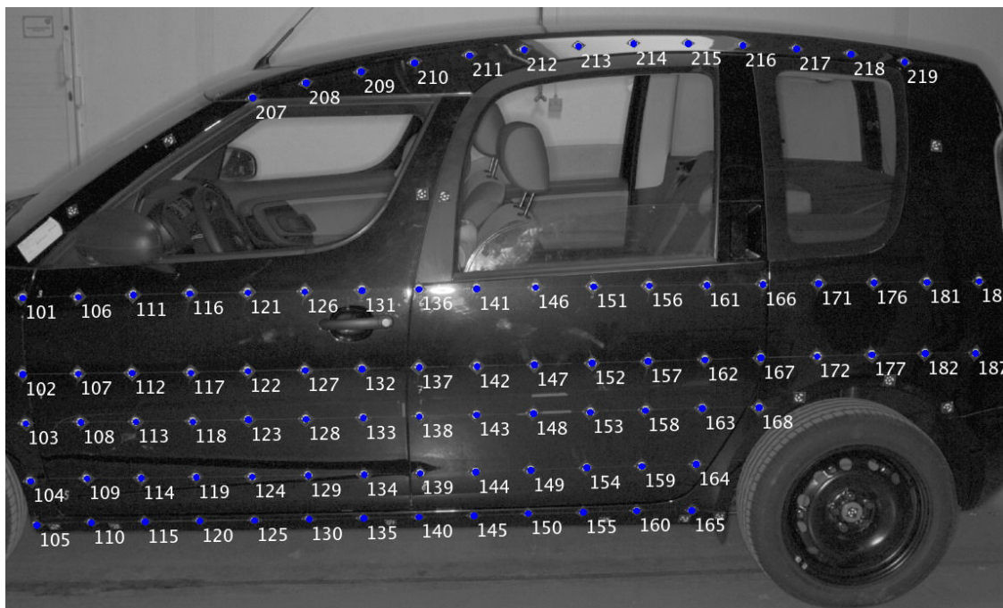
obrázek 32 : Rozmístění bodů na boku vozu
