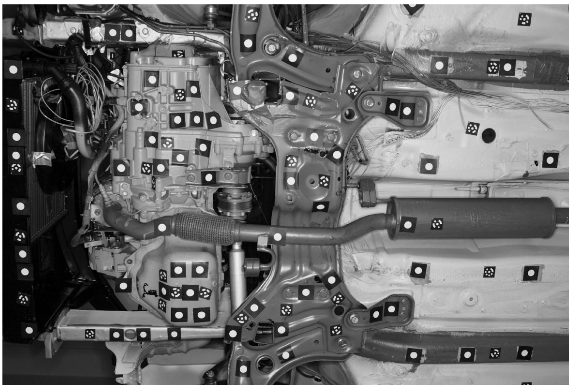
obrázek 42 : Umístění bodů na spodní části vozu
