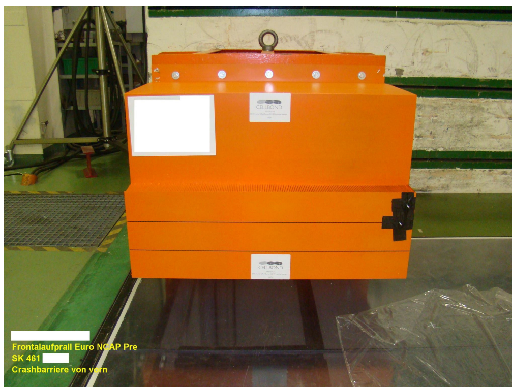
obrázek 10 : Deformovatelná bariéra pro čelní náraz
