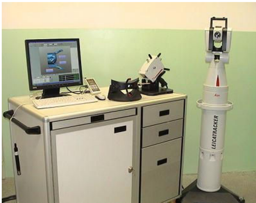
obrázek 51 : Leica Tracker TLC700 a příslušenstvím, měřicí ústředna
