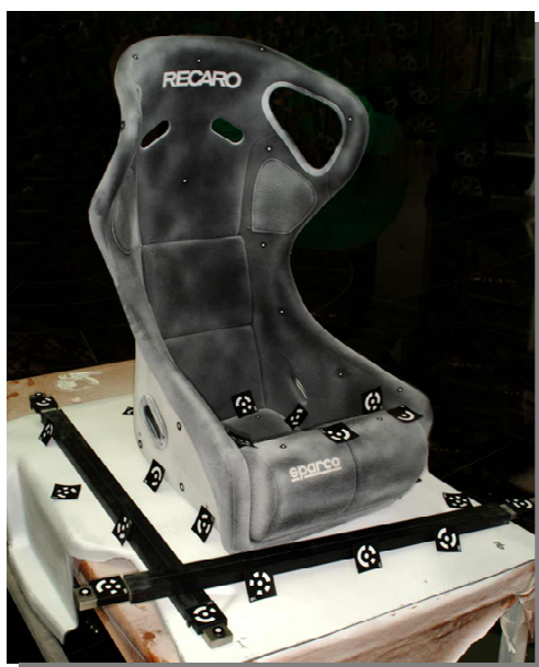
obrázek 27: Focení tritopem a naskenovaný model pomocí Atosu
