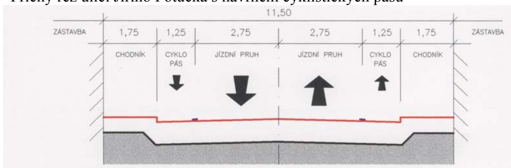
Obr. 6 – Příčný řez ulicí Jiřího Potůčka s návrhem cyklistických pásů
