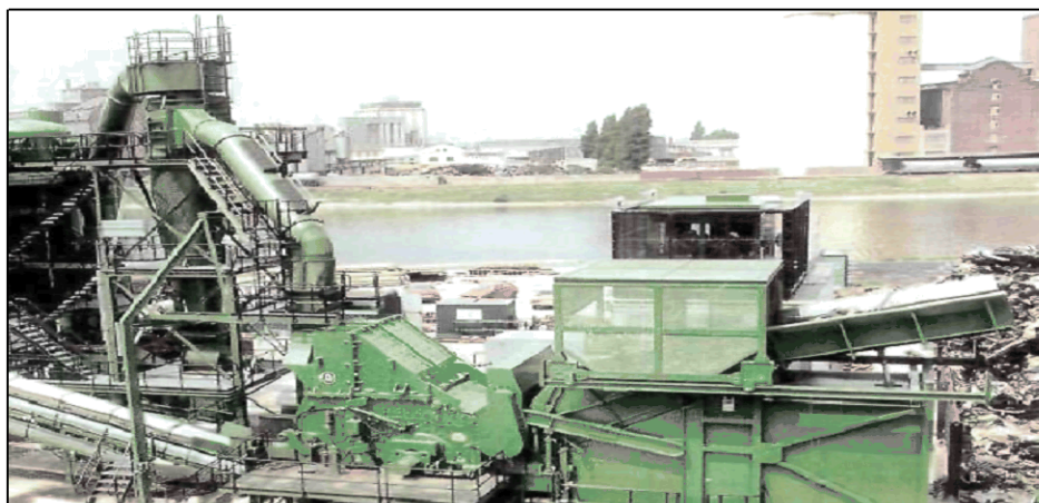
Obr. 4 - Drcení zbytku autovraku a separace materiálových frakcí
