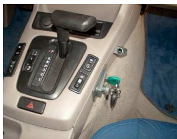
Obr. 23 Defend Lock – Převodovka [3]
