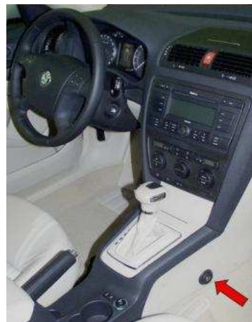
Obr. 10 Škoda Octavia II – boční zámek [3]
