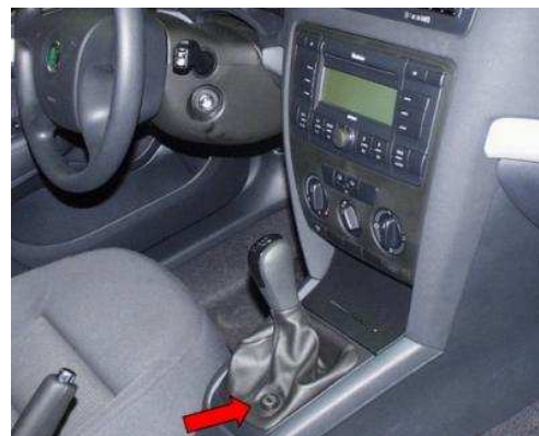
Obr. 12 Škoda Octavia II – horní zámek [3]
