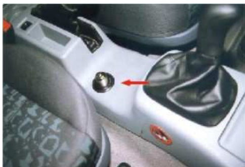
Obr. 11 Škoda Octavia I – horní zámek [3]
