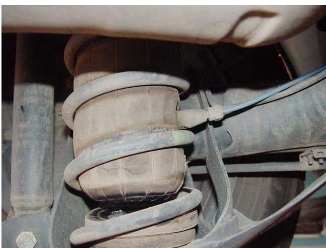
Obr. 3.9 Montáž vzduchového vaku do vinuté pružiny
