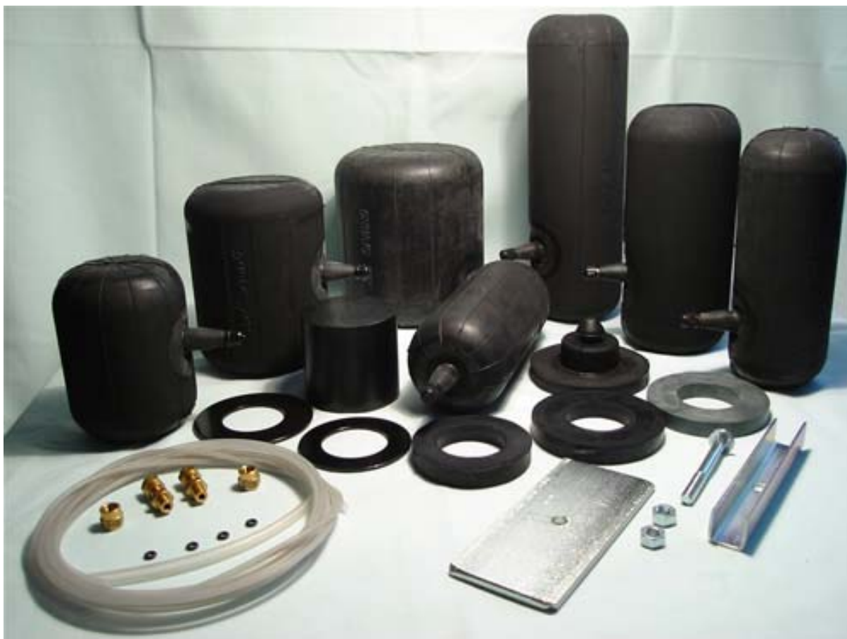
Obr. 3.8 Přídavné vaky vzduchového pérování
