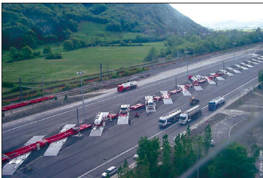
Obrázek č. 5 Rozložení terminálu systému Modalohr Zdroj: www.modalohr.com
