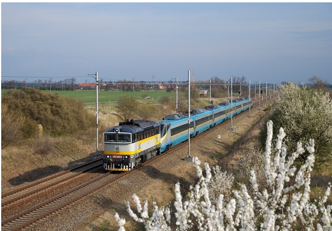
Obrázek 6 Napěťová výluka na trati, řešená příprěžným hnacím vozidlem
