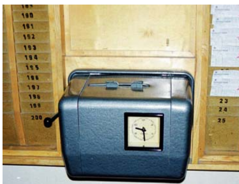
Obr 2 Mechanické píchací hodiny
