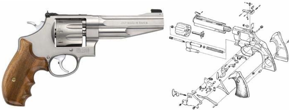
Obrázek č. 1.2: Revolver Smith&Wesson 627 (vlevo) a prostorový nákres revolveru. [9]
