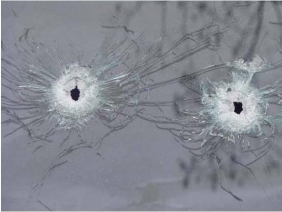
Obrázek č. 55: Přední okno, průstřel.
