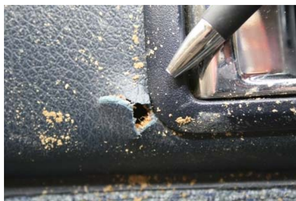
Obrázek č. 16: Vnitřní čalounění, výstřel.
