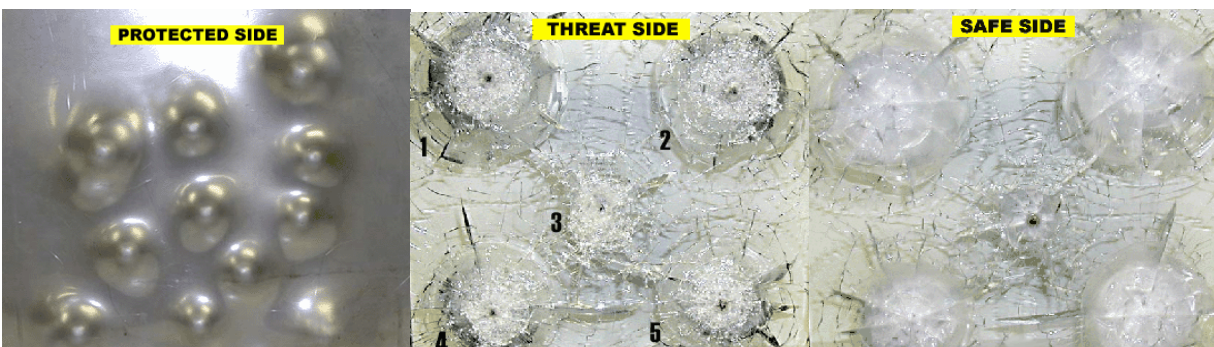
Zkoušené vzorky pancíře a balisticky odolného skla po zásahu ráží 44 Magnum a 7,62x39.
