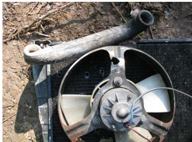
Obrázek č. 48: Držák ventilátoru, průstřel.
