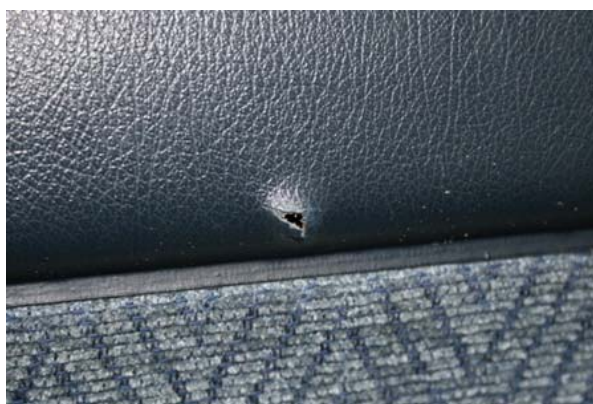
Obrázek č. 10: Vnitřní čalounění, výstřel.
