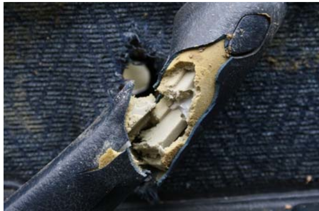
Obrázek č. 58: Vnitřní čalounění, výstřel.
