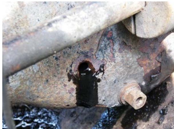
Obrázek č. 22: Olejová vana, průstřel.
