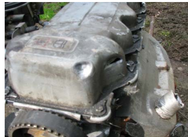
Obrázek č. 72: Víko rozvodů, prohlubeň.
