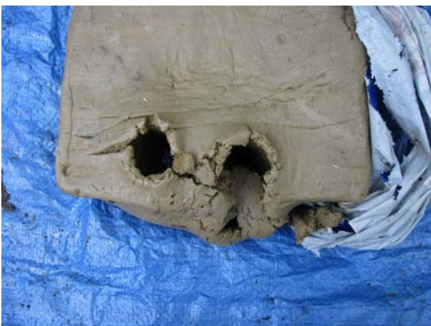
Obrázek č. 65: Blok hlíny, 2x průstřel.
