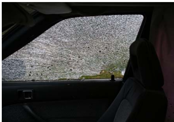
Obrázek č. 28: Boční okno, průstřel.
