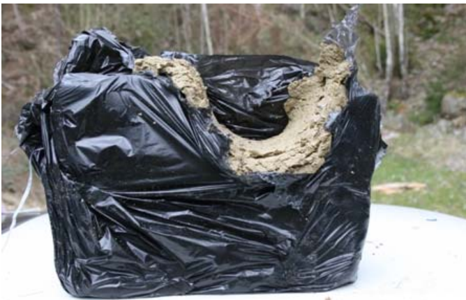
Obrázek č. 59: Blok hlíny, destrukce.
