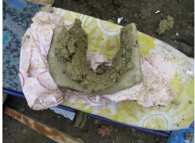
Obrázek č. 44: Blok hlíny, destrukce.
