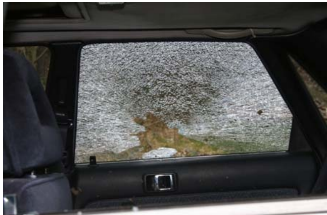
Obrázek č. 56: Boční okno, průstřel.
