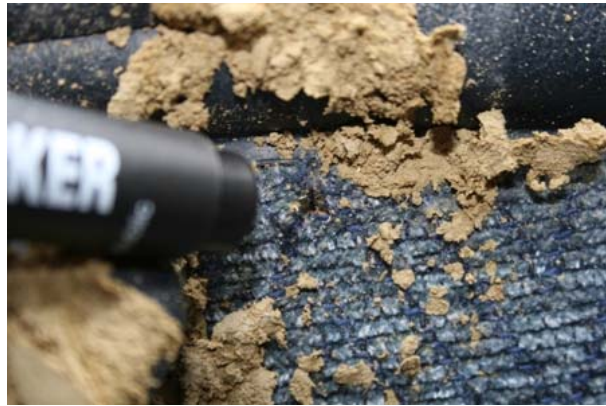
Obrázek č. 38: Vnitřní čalounění, průstřel.
