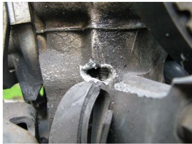
Obrázek č. 50: Hlava válců, průstřel.
