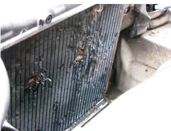
Obrázek č. 45: Chladič, průstřel.
