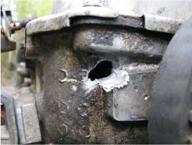
Obrázek č. 49: Hlava válců, průstřel.
