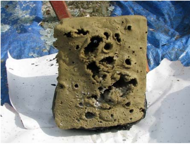
Obrázek č. 67: Blok hlíny, broky 3,5 mm.
