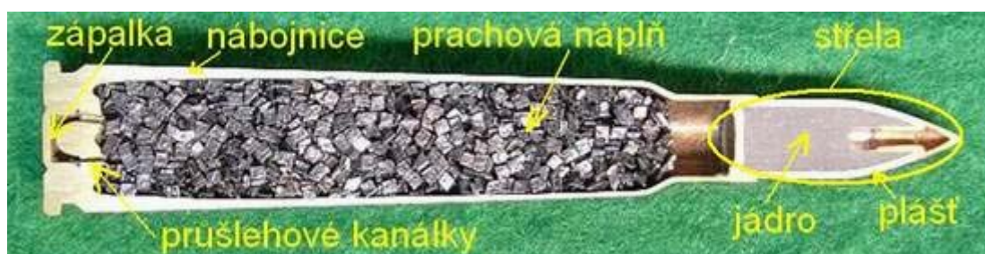
Obrázek č. 1.7: Řez kulovým nábojem. [11]
