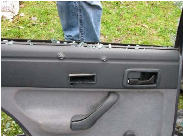
Obrázek č. 64: Vnitřní čalounění, broky 8,6 mm.
