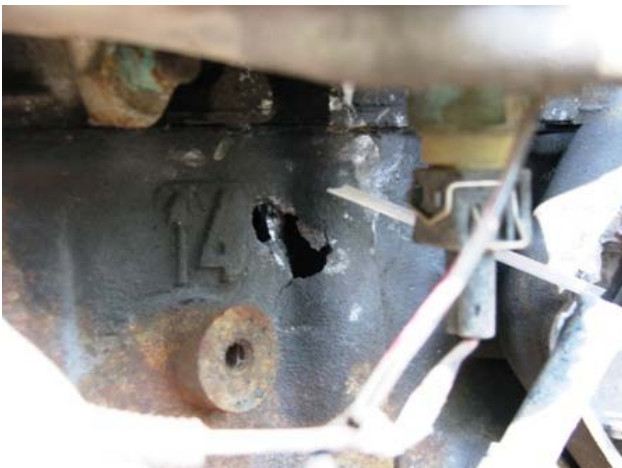
Obrázek č. 47: Blok motoru, průstřel.
