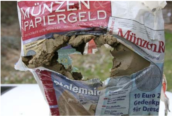
Obrázek č. 39: Blok hlíny, průstřel.
