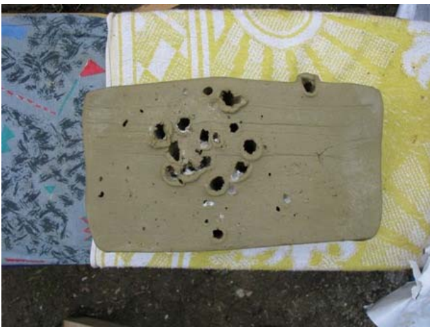
Obrázek č. 69: Blok hlíny, broky 3,5 mm.
