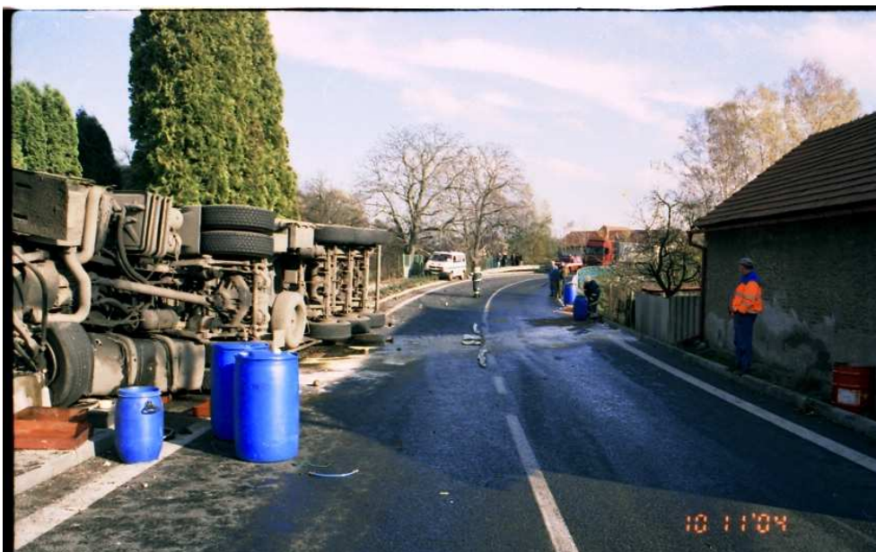
Obr. 5. Záchytné barely a vany u vozidla a dále znečištěná komunikace s únikem nafty do kanálové vpusti
