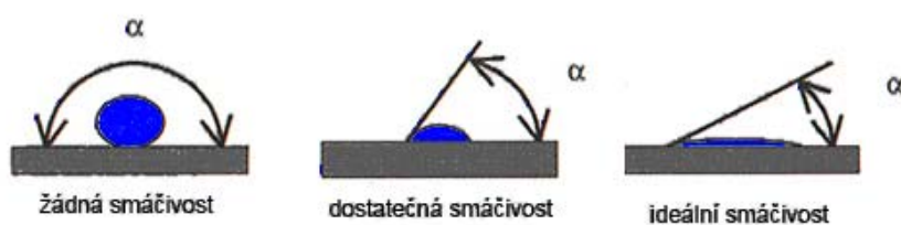
Obrázek 1: Schéma různých stupňů smáčivosti (zdroj: autor)
