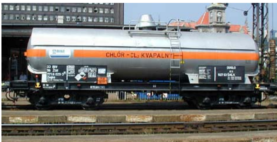
Obrázek 5: Označení kotlového vozu pro přepravu chlóru [8]
