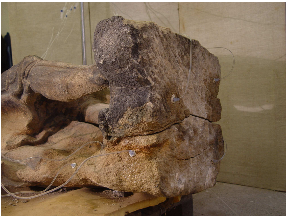
Obr. 14 průběh restaurování - hloubková injektáž sochy pomocí infuzí
