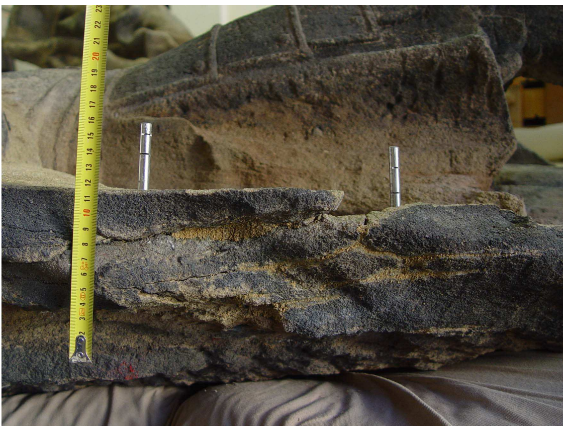
Obr. 18 stav před restaurováním - praskliny na pravé straně pláště
