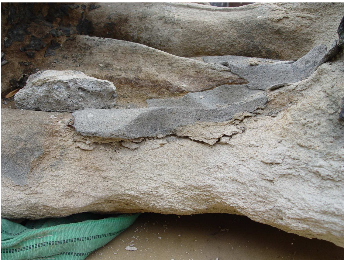
Obr. 10 stav před restaurováním - korodovaný kámen pod tmelem na zadní straně sochy
