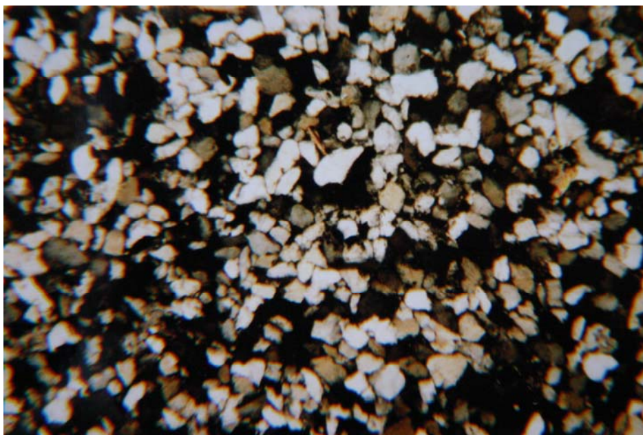
Obr. 78 Místo odběru: řasení pláště. 32 x zvětš. , nikoly X. Struktura, přev. křem. klasty, akces. Slída, živec. Pískovec křemenný jemnozrný.
