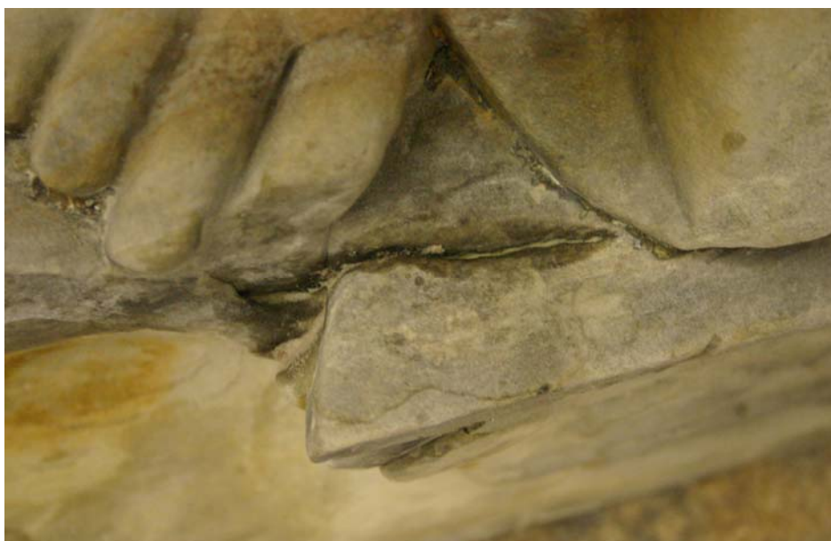
Obr. 29 Prasklina vyplněná injektáží směsí Funcosilu KSE 500 E s plnivem Füllstof A
