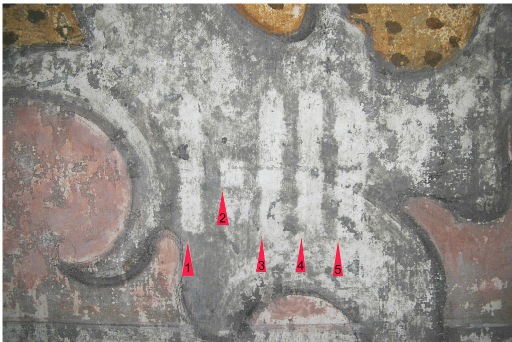
Obr. 3 Zkoušky dočišťování směsí čpavkové vody, destilované vody, acetonu v různých poměrech a koncentracích (popis str. 43)
