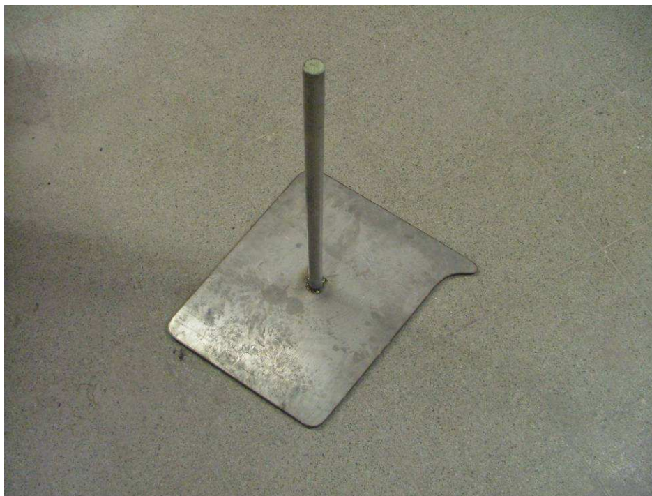
Obr.28. Deska a čep, armatury pro zajištění dolní části sochy
