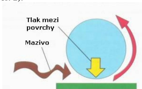
Obr. 2 Princip hydrodynamického mazání [5]
