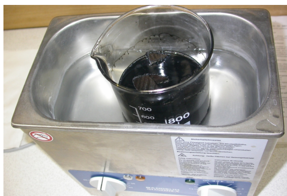
Obr. 31 Ultrazvuková lázeň Bandelin Sonorex s kádinkou, v níž je v rozpouštědlové směsi umístěna rozřezaná filtrační vložka (vlastní foto)
