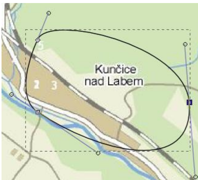
Obrázek č. 2.9 Ukázka z programu Inkscape, výběr oblasti pomocí Bézierovy křivky, viditelná konvexní obálka a řídicí body.
