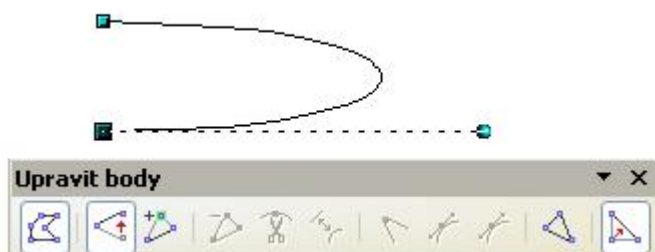
Obrázek č. 3 Ukázka z programu OpenOffice.org Draw, Bézierova křivka, 4 body, úprava 1 řídicího bodu a jeho vektoru
