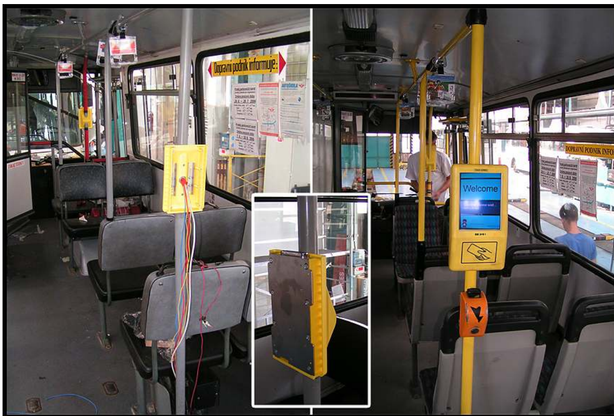
Obr. 33: Namontované držáky a celkový pohled na testovací čtecí zařízení
