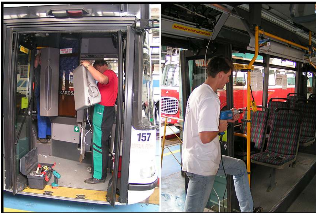
Obr. 32: Příprava pro držáky čtecích zařízení
