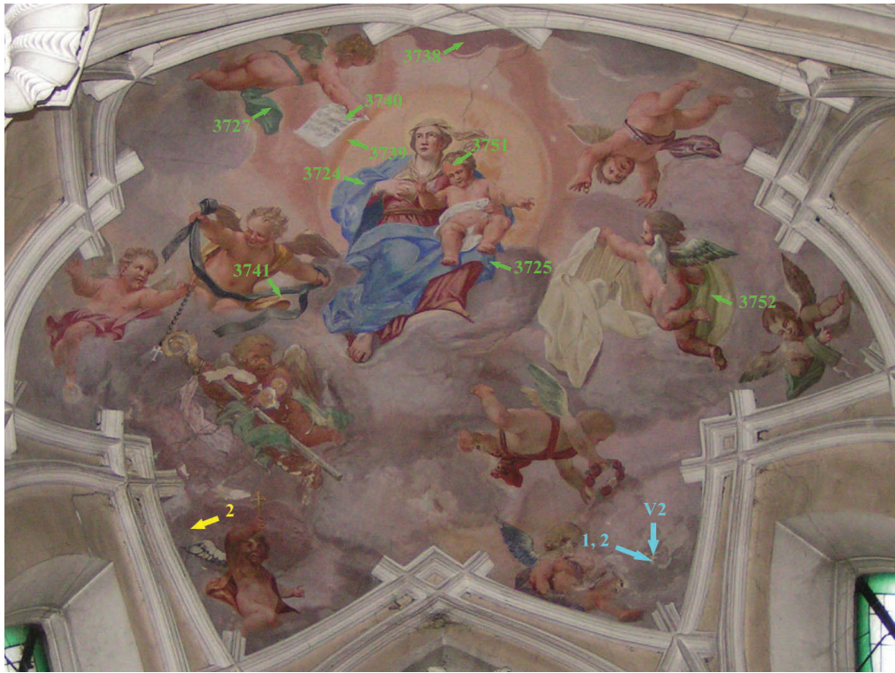
Obr. 5 Místa odběru vzorků; zeleně jsou vyznačené odběry pigmentů, žlutě odběr plísní, modře odběr solí.
