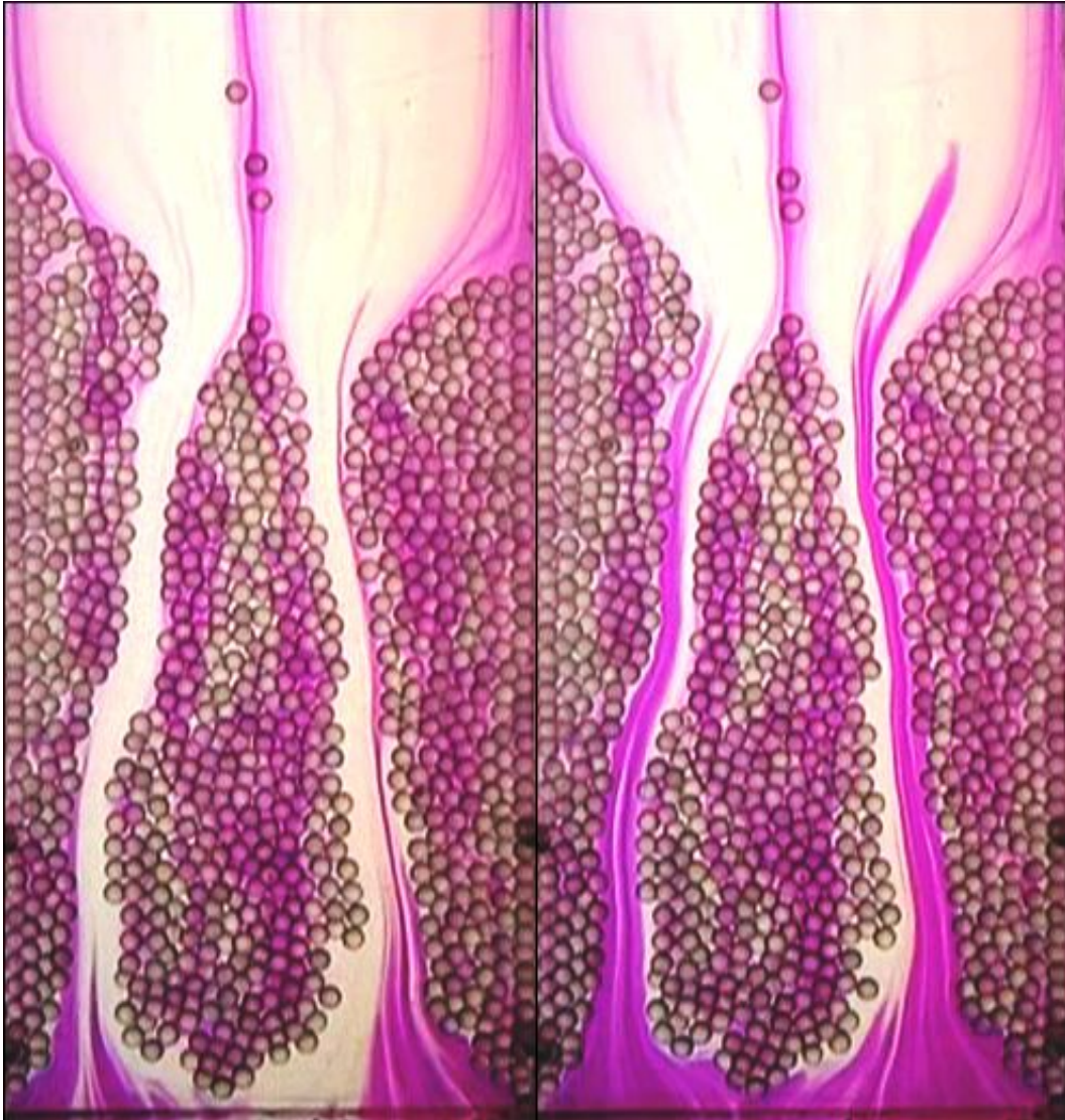
Obrázek 8: Barevné snímky ze systému B-PR-F-6b zachycující tvorbu většího počtu vláken obarvené kapaliny nad roštem
