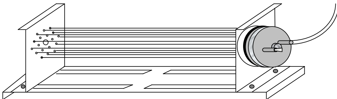
Obrázek 26: Utěsnění dutých vláken
