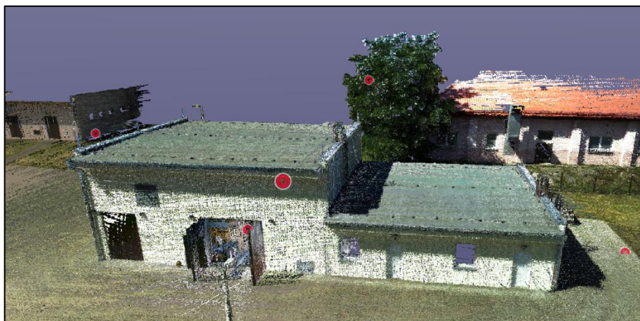
Obrázek 35 - Výstupy z autonomního létajícího laserového skeneru – požárníště F (Zdroj: vlastní)
