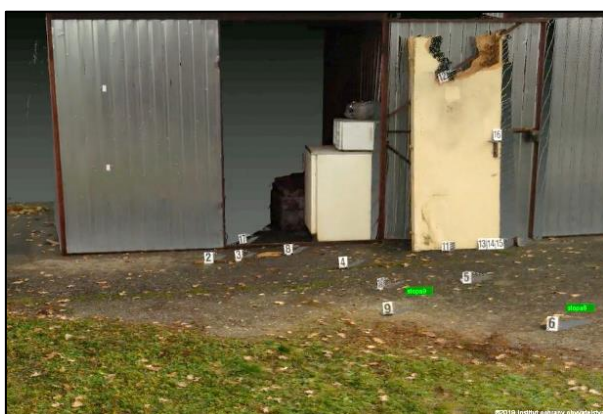
Obrázek 43 – 3D model místa po výbuchu s označením stop (Zdroj: vlastní)
