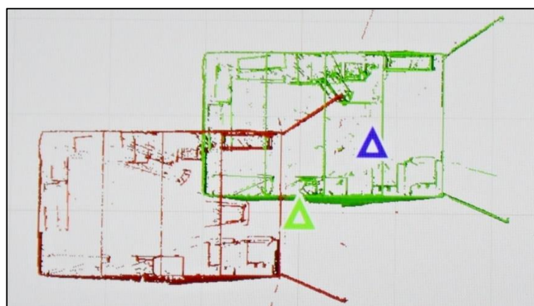
Obrázek 29 - Registrace skenu č. 2 ke skenu č. 1 (Zdroj: vlastní)
