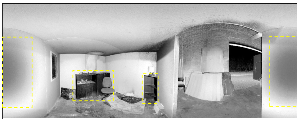
Obrázek 58 - Rozvinutý sférický snímek ze skeneru FARO X130 (Zdroj: vlastní)
