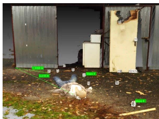
Obrázek 44 – Výsledný 3D model s tělem a označenými stopami (Zdroj: vlastní)
