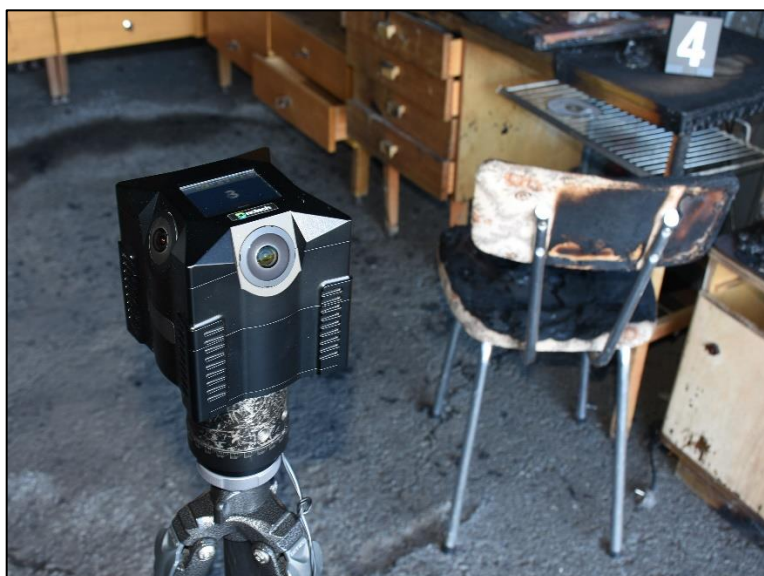
Obrázek 10 – ISTAR Fusion 360 od NCTech (Zdroj: vlastní)
