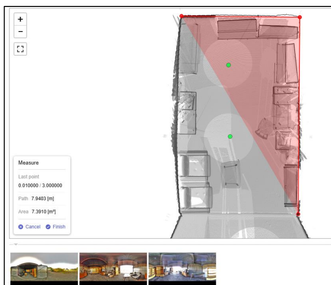
Obrázek 40 – Ukázka výstupu virtuální prohlídky sférických snímků ze SW PointCab, na kterých lze provádět měření (Zdroj: vlastní)
