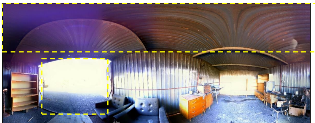
Obrázek 71 - Sférický snímek ze skeneru Trimble X7 – fotografie bez HDR – stanoviště č. 2 (Zdroj: vlastní)
