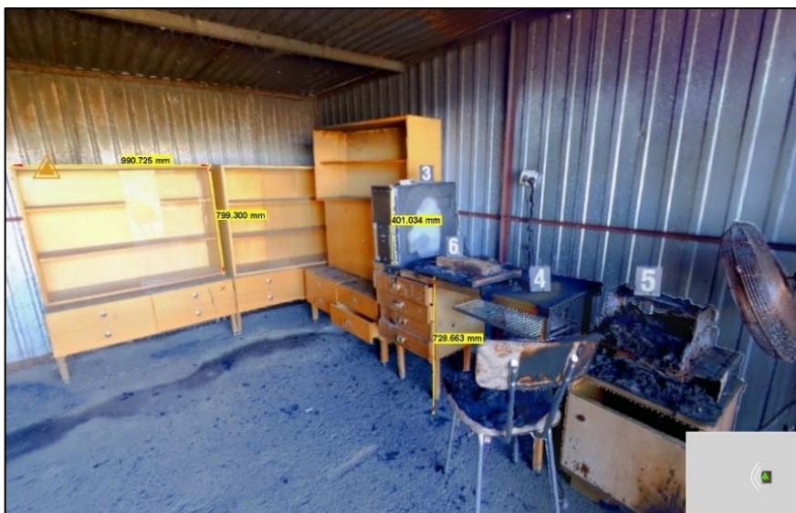
Obrázek 39 – Ukázka výstupu virtuální prohlídky sférických snímků ze SW ReallWorks, na kterých lze provádět měření (Zdroj: vlastní)
