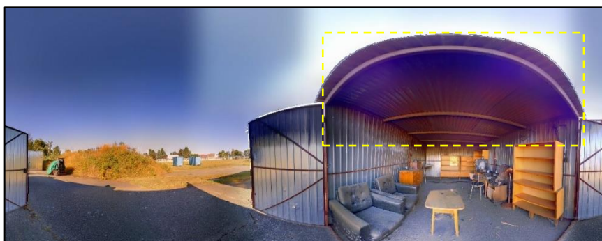
Obrázek 60- Sférický snímek ze skeneru Trimble X7 – fotografie s HDR - stanoviště č. 1 (Zdroj: vlastní)
