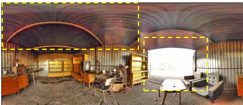
Obrázek 69 - Sférický snímek ze skeneru FARO X130 – stanoviště č. 2 – fotografie bez HDR s aplikovaným filtrem v SW FARO (Zdroj: vlastní)
