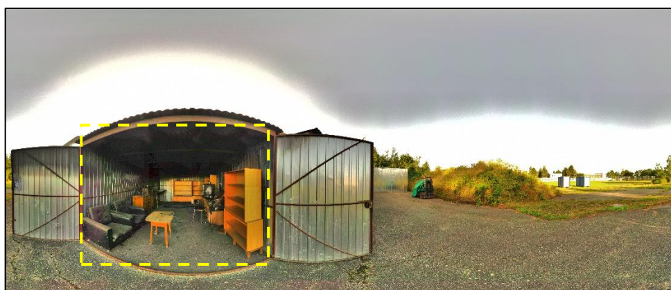
Obrázek 63 - Sférický snímek ze skeneru FARO X130 – stanoviště č. 1 – fotografie bez HDR s aplikovaným filtrem v SW FARO SCENE (Zdroj: vlastní)
