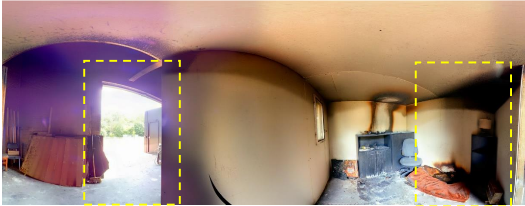
Obrázek 92 – Rozvinutý sférický snímek stanoviště 3 – zobrazení v HDR kvalitě s 15 snímky ze skeneru Trimble X7 (Zdroj: vlastní)
