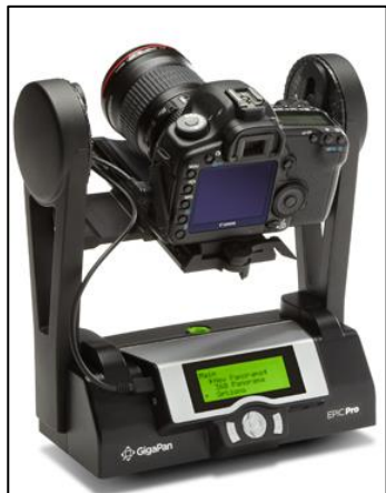
Obrázek 8 – Panoramatická hlava GigaPan Epic Pro (Zdroj: vlastní)
