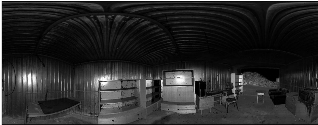
Obrázek 73 - Sférický snímek ze skeneru Trimble X7 – fotografie v IR spektru – stanoviště č. 3 (Zdroj: vlastní)
