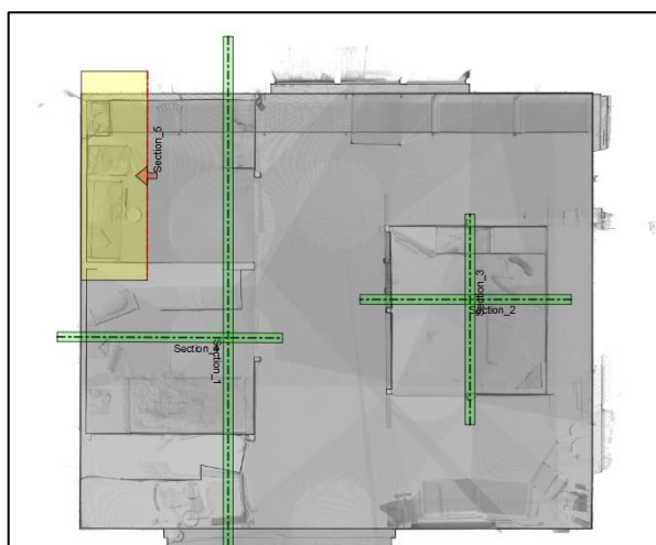
Obrázek 116 - Zobrazení řezů – sekcí v SW PointCab (Zdroj: vlastní)
