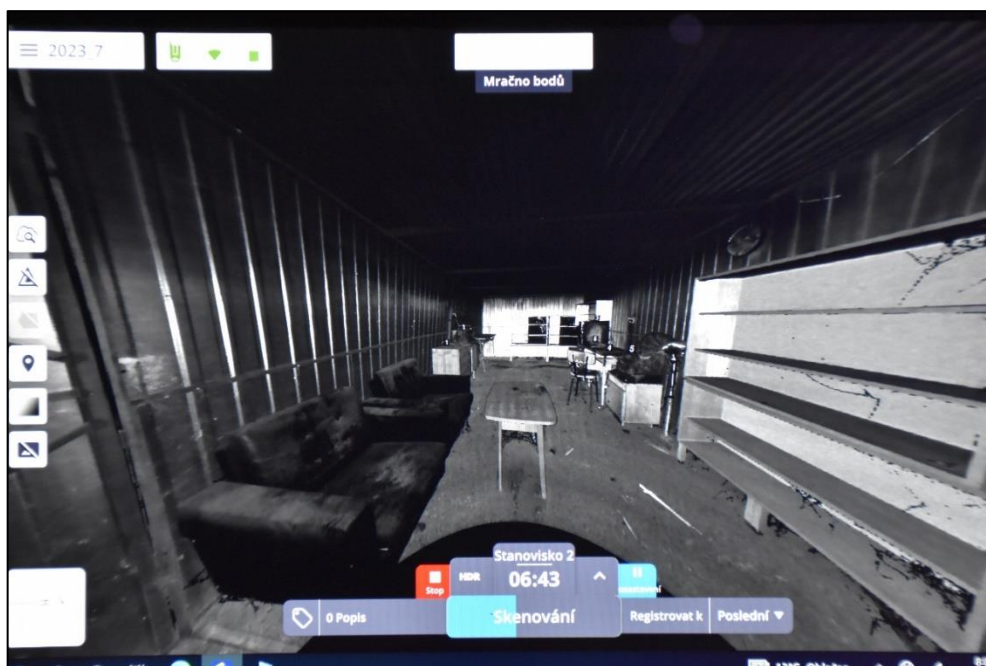
Obrázek 31 – Zobrazení na tabletu získaná 3D data (Zdroj: vlastní)
