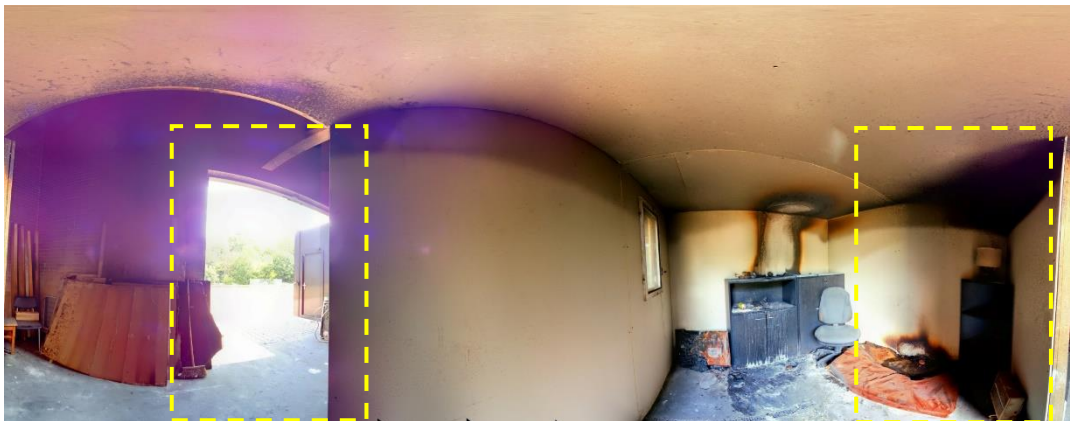
Obrázek 94 – Rozvinutý sférický snímek stanoviště 3 – zobrazení v HDR kvalitě s 30 snímky ze skeneru Trimble X7 (Zdroj: vlastní)
