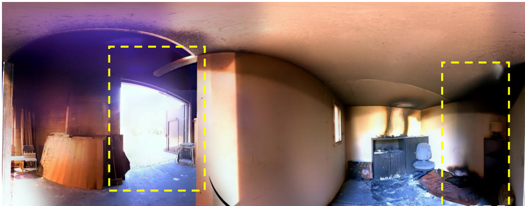
Obrázek 90 – Rozvinutý sférický snímek stanoviště 3 – zobrazení v bez HDR kvality snímku ze skeneru Trimble X7 (Zdroj: vlastní)
