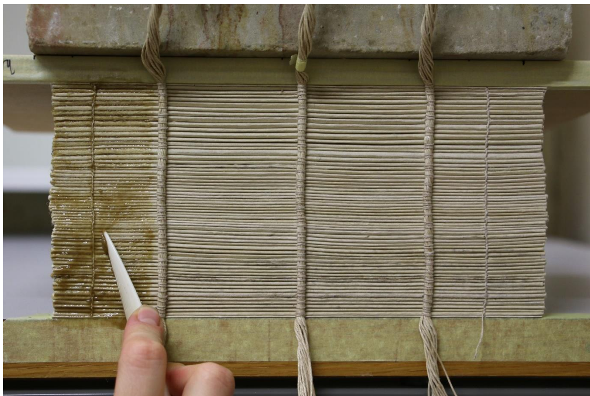
Obrázek 99 Klížení knižního bloku
