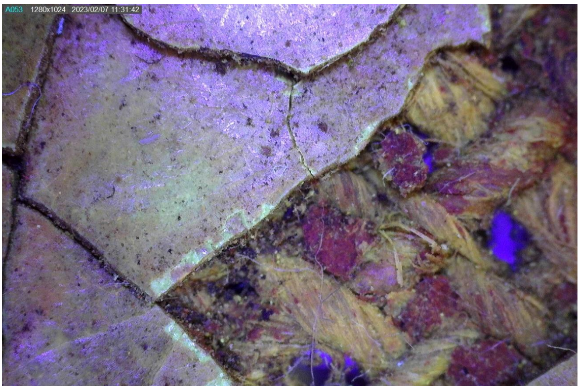
Obr. 19, USB mikroskopie, UV, obličej svěčky, ztráty barevné vrstvy a podkladu, oddělující se krakela
