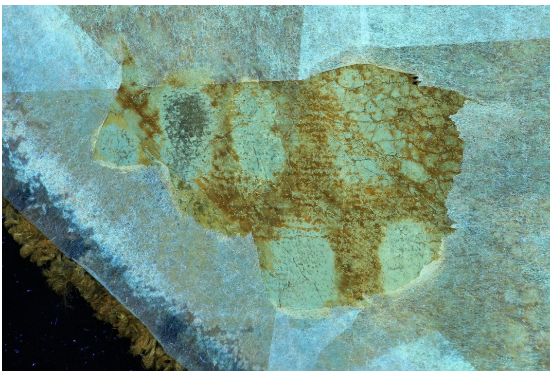
Obr. 59, Zkoušky ztenčování lakových vrstev, nahoře zleva: aceton, isooktan, isooktan; dole zleva: isopropylalkohol, směs terpentýnu a ethanolu, UV
