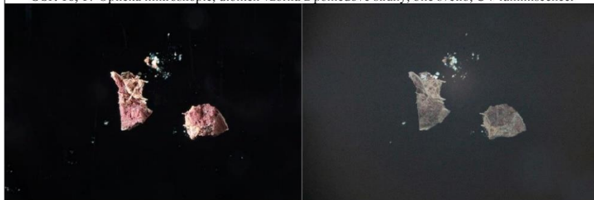
Obr. 18, 19 Optická mikroskopie, úlomek vzorku ze spodní strany, bílé světlo, UV luminiscence.
