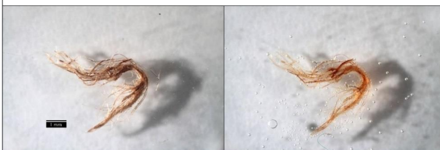
Obr. 46, 47 Optická mikroskopie, odražené světlo, před a po kontaktu s floroglucinem (zvětšení 50 ×).
