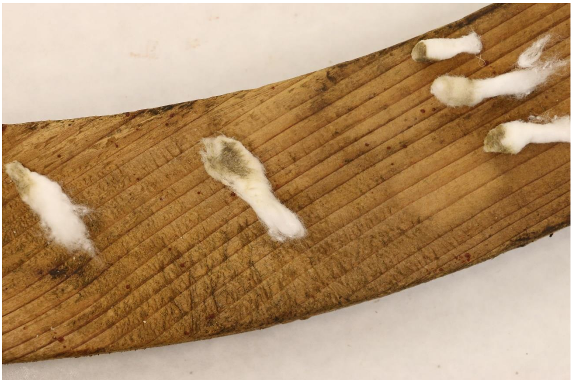
Obr. 47, Zkouška čištění rámu, zleva: demineralizovaná voda, ethanol; dále vpravo shora: demineralizovaná voda, 50% vodný roztok ethanolu, ethanol
