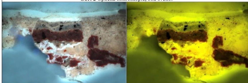
Obr. 3, 4 Luminiscenční mikroskopie: UV luminiscence/VIS luminiscence generovaná modrým světlem.
