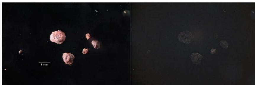
Obr. 32, 33 Optická mikroskopie, úlomek vzorku z pohledové strany, bílé světlo, UV luminiscence.
