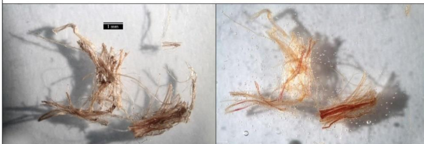
Obr. 40, 41 Optická mikroskopie, odražené světlo, před a po kontaktu s floroglucinem (zvětšení 50 ×).
