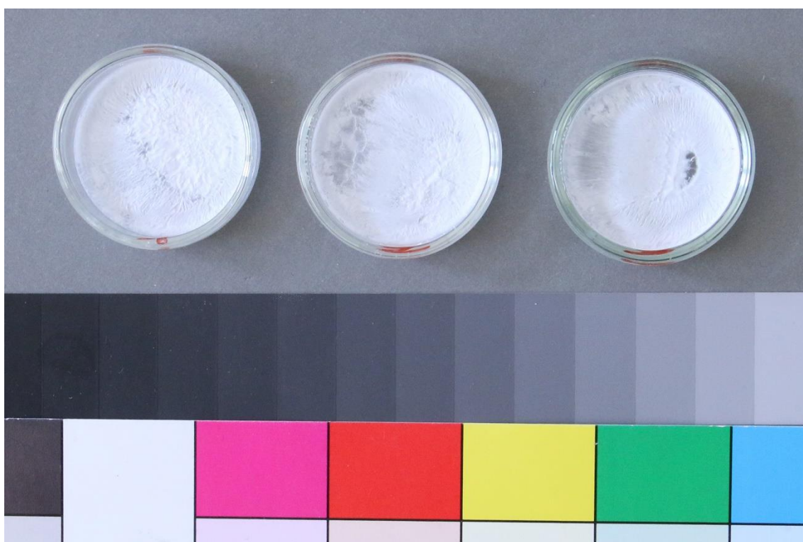
Obr. 106, Hmotnostní procento netěkavého podílu Nanorestore Cleaning® Apolar Coating , t_3
