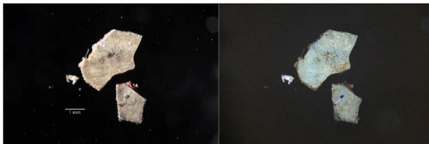
Obr. 7, 8 Optická mikroskopie, úlomek vzorku z pohledové strany, bílé světlo, UV luminiscence.
