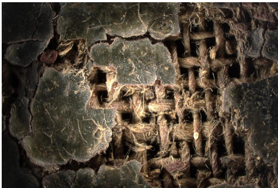
Obr. 36 Stav před restaurováním, detail výpadku barevné vrstvy a plátna, poškození nití, digitální mikroskop KEYENCE, zvětšení 20 ×
