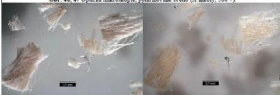
Obr. 48, 49 Optická mikroskopie, odražené světlo, před a po kontaktu s floroglucinem (50 ×).
