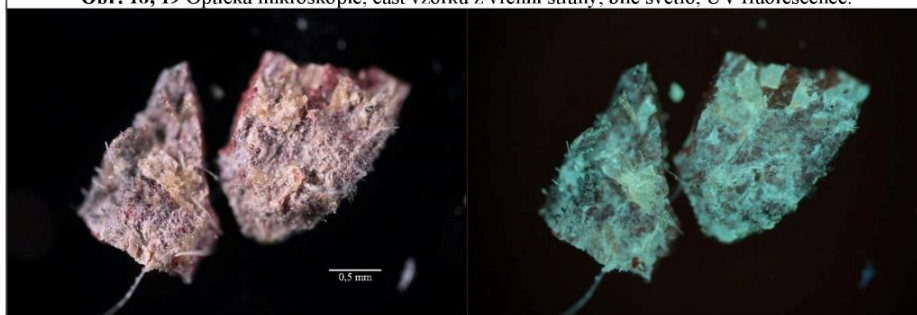
Obr. 20, 21 Optická mikroskopie, vzorek ze spodní strany, bílé světlo, UV fluorescence.
