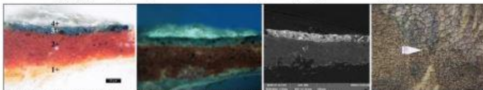
Obr. 72, 73 Optická mikroskopie, bílé světlo, UV fluorescence. Obr. 74 SEM, BSE. Obr. 75 Odběr vzorku.
