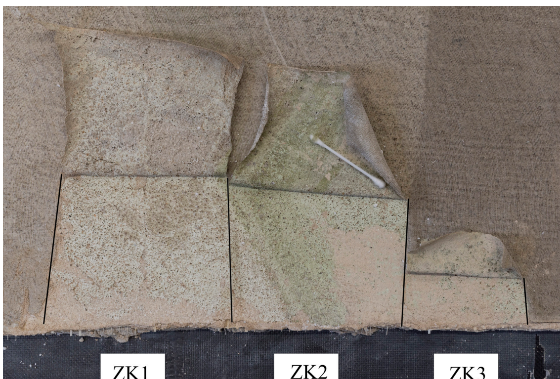
Obr. 131: Zkoušky odstranění přelepové gázy. ZK1 - teplá voda v arbocelu doba působení 40 minut, ZK2 - teplá voda v arbocelu doba působení 20 minut, ZK3 - pomocí páry, ZK4 - etylacetát s etanolem v objemovém poměru 1:1 (dohromady 80 ml) a 2 ml destilované vody, směs aplikovaná v arbocelu, doba působení 2 minuty. V místě levého okraje dílu IK nad andílkem, fotografie stavu za mokra.
