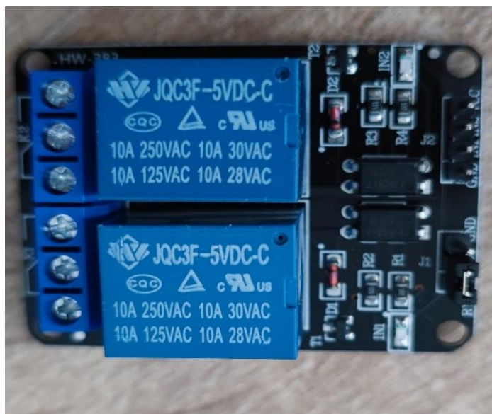
Obrázek 4.36: Náhled na modul s Relé pro spínání zdrojů. (Zdroj: Vlastní.)
