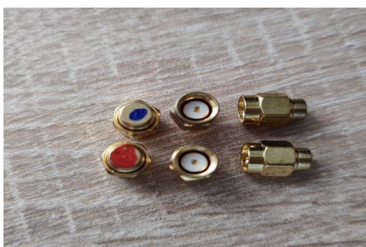
Obrázek 4.1: Náhled na použité zakončovací impedance 50\ \Omega v provedení SMA. (Zdroj: Vlastní.)
