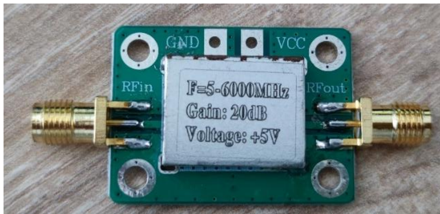
Obrázek 4.15: Náhled na použitý modul zesilovače se SBB5089Z. (Zdroj: Vlastní.)
