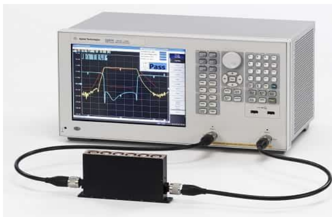
Obrázek 2.1: Příklad měřicího pracoviště pro měření S-parametrů vektorovým analyzátozem, převzato z (Baby, 2022).
