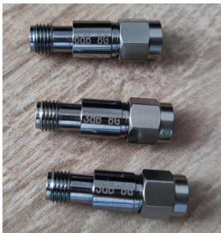
Obrázek 4.8: Náhled na použité pevné atenuátory s přechody SMA. (Zdroj: Vlastní.)
