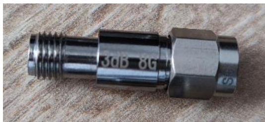
Obrázek 1.7: Reálná podoba zakoupeného atenuátoru s SMA-SMA bránami. (Zdroj: Vlastní.)
