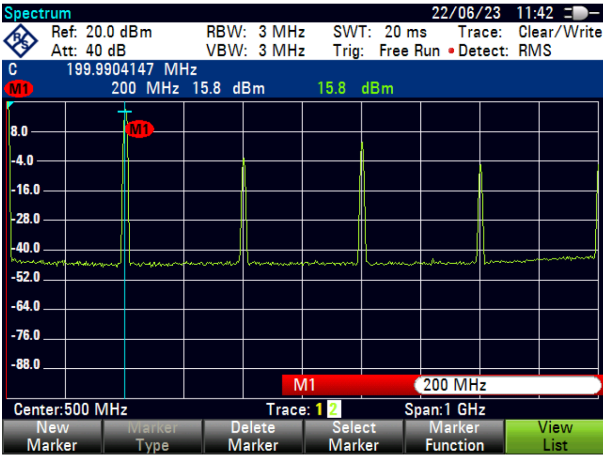
Obrázek 8.12: Náhled na maximální dosahovaný výkon z výstupního portu 1 – pro nízké frekvence. (Zdroj: Vlastní.)
