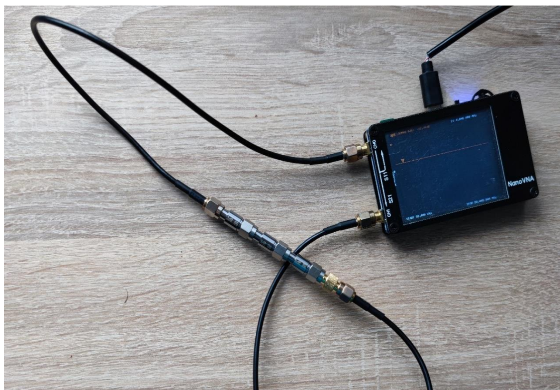
Obrázek 10.22: Ukázka měřícího pracoviště při měření atenuátoru 12 dB s NanoVNA. (Zdroj: Vlastní.)
