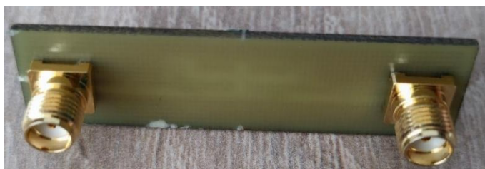
Obrázek 1.10: Podoba osazeného filtru dolní propusti s PI článkem, spodní strana. (Zdroj: Vlastní.)
