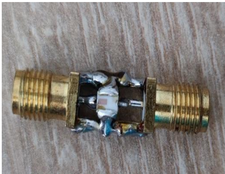
Obrázek 1.12: Reálná podoba dvojbranu s keramickým filtrem vlastní výroby. (Zdroj: Vlastní.)
