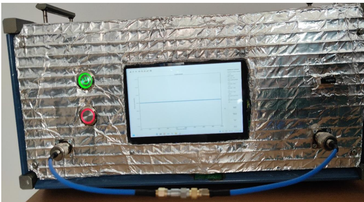
Obrázek 10.10: Ukázka měřicího pracoviště při měření atenuátoru 6 dB. (Zdroj: Vlastní.)
