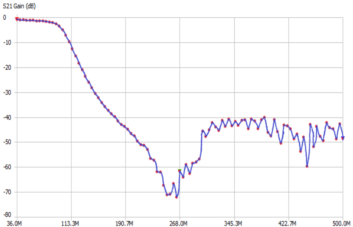
Obrázek 10.38: Ukázka naměřených dat při měření s-parametru |S21| filtru LFCV-52+ s NanoVNA. (Zdroj: Vlastní.)
