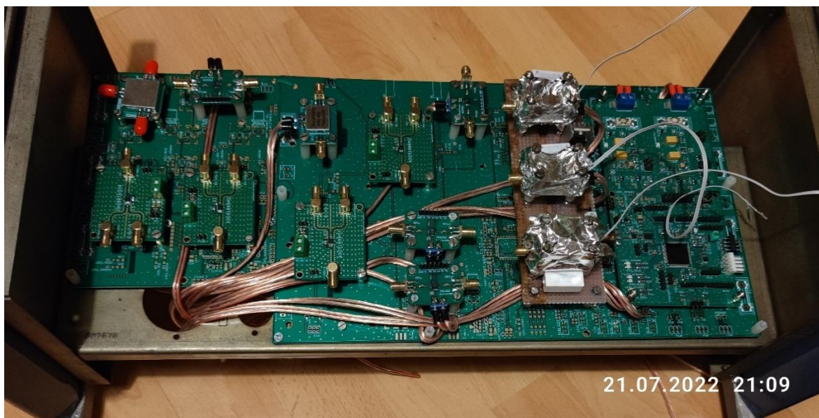
Obrázek 7.3: Náhled na osazený blok přijímací části do krabice. (Zdroj: Vlastní.)
