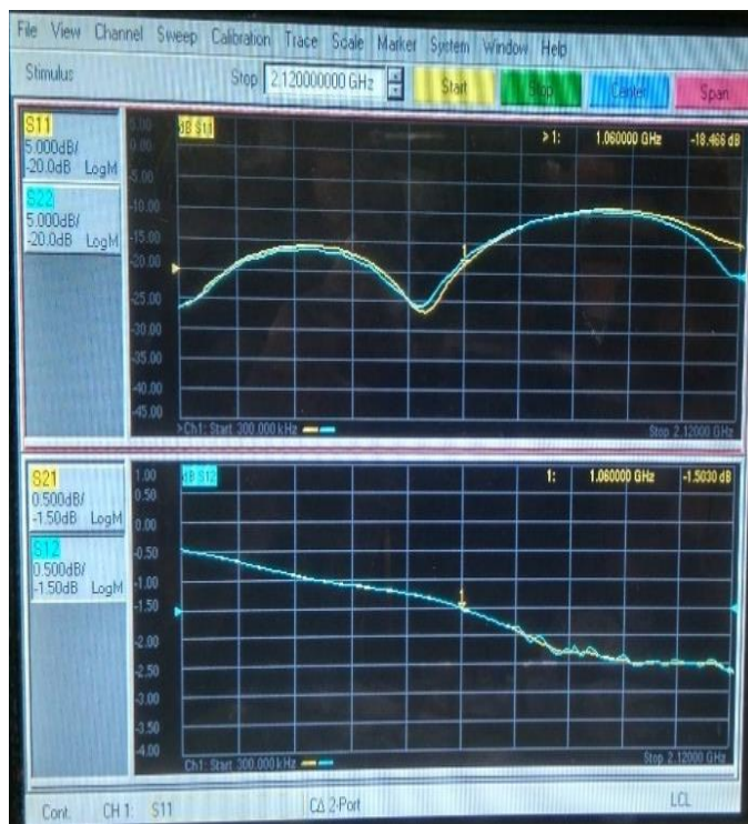
Obrázek 5.2: Náhled na měření přizpůsobení DPS s obvodem ADG918, převzato ze (Kopecký, 2021).
