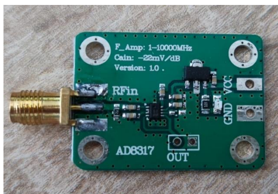
Obrázek 4.11: Náhled na použitý modul s AD8317. (Zdroj: Vlastní.)
