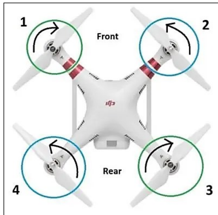
Obrázek 13 Princip pohybu vrtulí na bezpilotním prostředku
