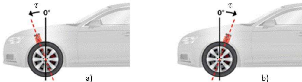
Obr. 16: Záklon rejdové osy \tau . a) negativní, b) pozitivní [9]
