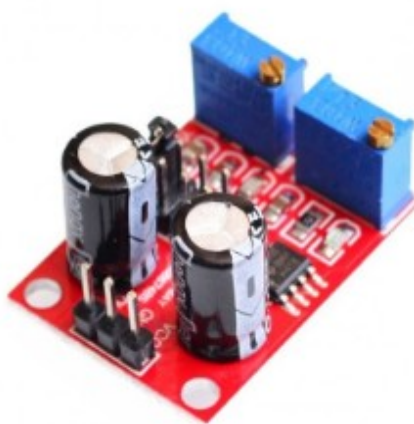
Obrázek 18: Generátor obdelníkového signálu [17]
