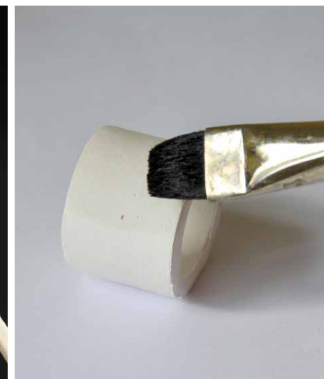
8.3.3. Aplikace konsolidačního prostředku na zkušební tělesa nátěrem pomocí měkkého štětce. (foto: P. Zítková)
