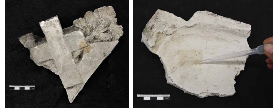
8.3.5. Průběh konsolidace fragmentů modelu „návrhu č. 1“ organokřemičitým zpevňovacím prostředkem KSE 100. (foto: P. Zítková)
