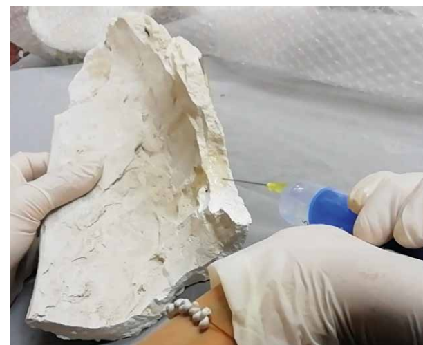
8.3.9. Průběh konsolidace: degradovaný povrch byl nejprve napuštěn organokřemičitanem KSE 100 a následně byla aplikována směs vápenné nanosuspenze CaLoSiLu E25 a KSE 100 v poměru 1:1. (foto: P. Zítková)
