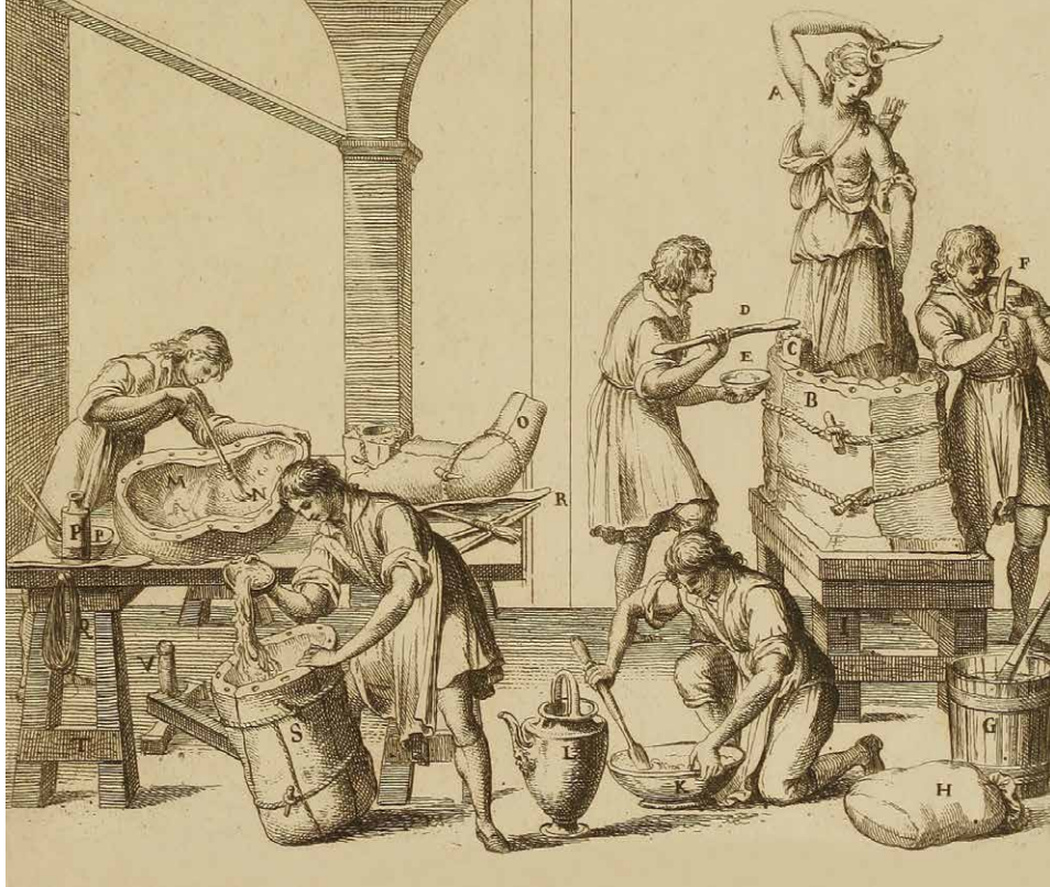
3.1. Pohled do štukatérské dílny s vyobrazením různých fází zhotovení formy (zdroj: CARRADORI, Francesco a Matti AUVIENEN. Elementary instructions for students of sculpture)
