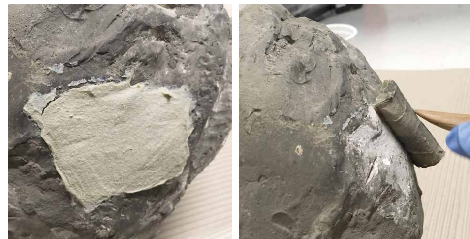
8.2.2. Zkouška čištění pomocí pasty z attapulgitu a karboxymethylcelulózy. Po důkladném rozmíchání směsi s vodou se pasta nanáší nejprve v tenké homogenní vrstvě a poté v druhé vrstvě do 2–4 mm celkové tloušťky. Po 12–24 hodinách se zábal sám z povrchu uvolní spolu s čištěnými depozity. (foto: P. Mrovčec)
