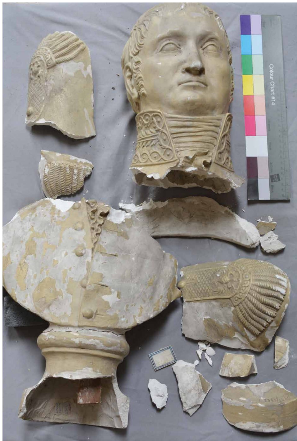
8.3.7. Busta F. Dvořáka byla rozlomená na několik částí a hmota sádry byla výrazně degradovaná. (foto: P. Zítková)
