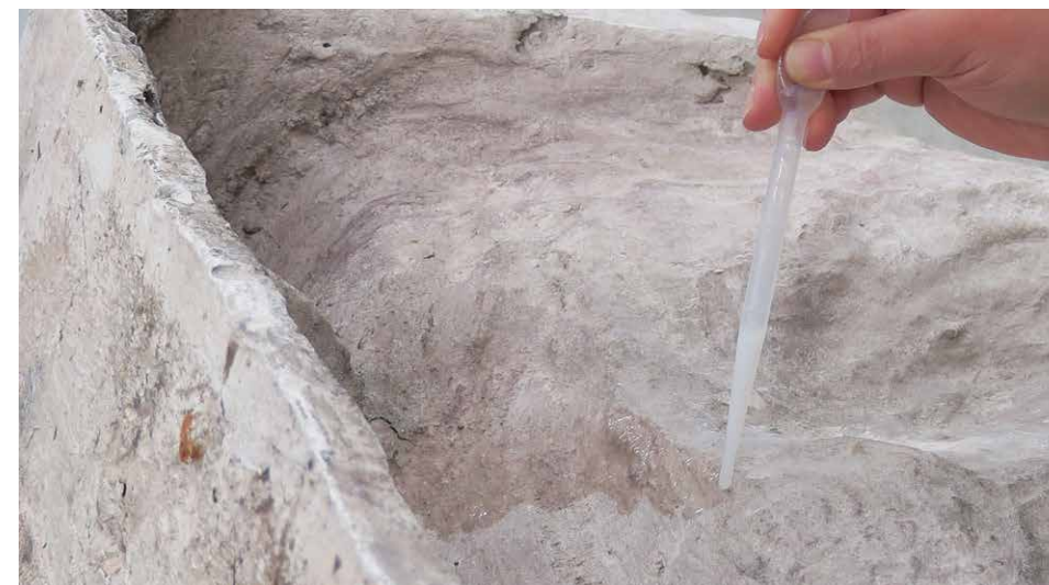
8.3.6. Aplikace konsolidantu laboratorní pipetou. Na degradovaný povrch zadní strany nepatinovaného modelu byla zvolena kombinace vápenné nanosuspenze CaLoSiL E25 a organokřemičitanu KSE 100 v poměru 1:1. (foto: K. Šibravová)
