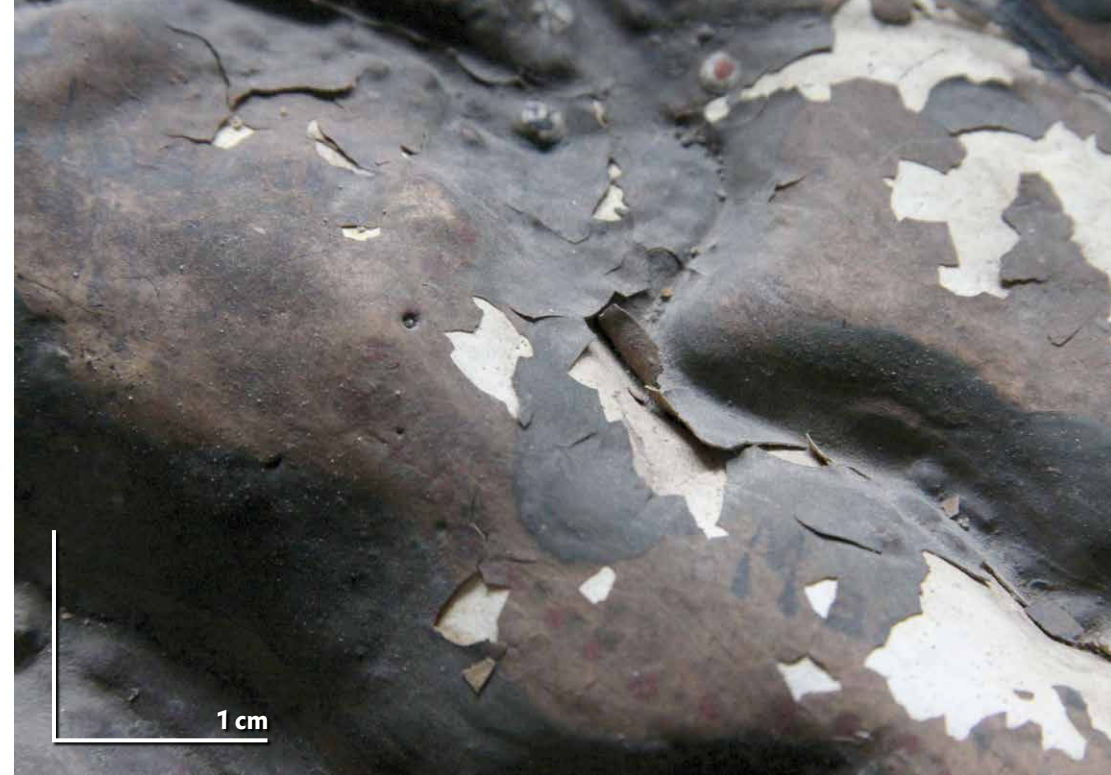
6.7. Detail rozsáhlého poškození barevné vrstvy na sádrovém odlitku zapříčiněného kombinací vysoké teploty a vlhkosti. (foto: P. Zítková)
