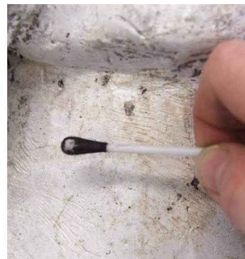
8.3.11. Stěr tmavou vatovou tyčinkou použitý pro hodnocení míry soudržnosti povrchu. (foto: P. Zítková)
