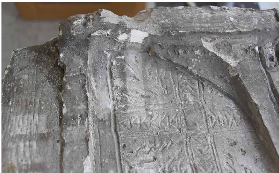
8.2.7. Zkoušky čištění na různých površích. Zkoušky agarem i mikropískováním přinesly poměrně dobré výsledky, ale při zkoumání v UV světle se ukazuje fluorescence kolem místa čištěného agarem, která je způsobena penetrací média do porézního systému substrátu. (foto: Z. Auská)
