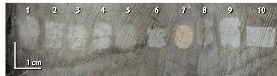
8.2.14. Zkoušky čištění: 1. plastická guma Faber Castell ; 2. plastická guma KOH-I-NOOR ; 3. guma – tvrdý blok Hardtmuth 300/60 ; plastická guma Art Eraser Kneaded Soft ; 5. latexová houba Wishab ; 6. laser EOS 1000 ; 7. laser Thunder Art ; 8. kaučukový latex Arte Mundit ; 9. agar; 10. Laponit RD . (foto: P. Zítková)
