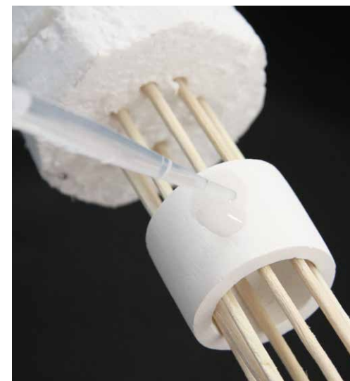
8.3.2. Aplikace konsolidačního prostředku na zkušební tělesa kontinuálním kapáním. (foto: R. Tišlová)
