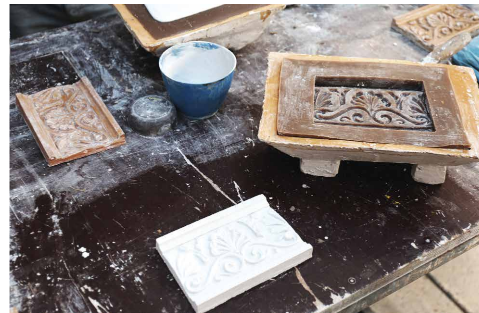
3.2. Želatinová forma umožňovala formování jemných detailů či zhotovení více odlitků z jedné formy. (foto: P. Zítková)
