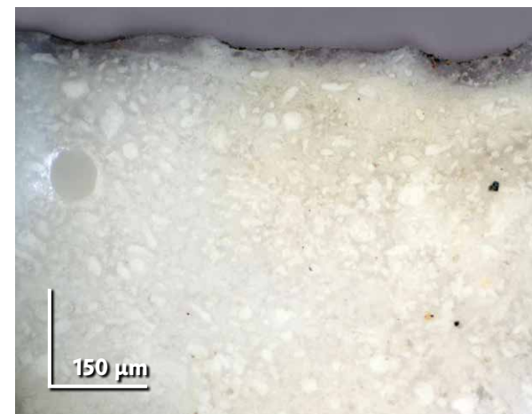
8.2.9. Nábrus vzorku odebraného pro identifikaci případné povrchové úpravy a způsobu depozice nečistot. Ze vzorku je patrné, na kolik jsou depozity zanesené do porézního systému a že sádra pravděpodobně nebyla nijak povrchově upravována. Snímek z optického mikroskopu v bílém viditelném a UV světle. (foto: P. Lesniaková)
