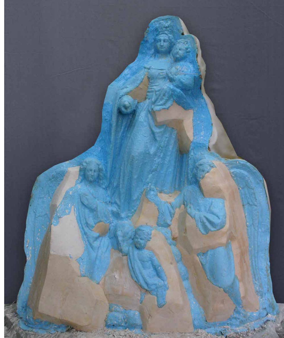
3.3. Průběh práce na silikonové formě. Na model je nanášena vrstva pružného silikonu a protitvary jsou postupně zaplňovány sádrovými klíny. Po uzavření všech protitvarů je celá strana překryta sádrovým kadlubem. (foto: M. Kulhánek)
