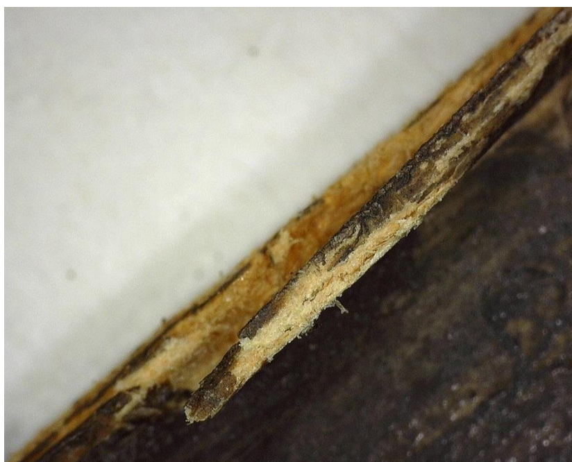
Obr. 91 Stav před restaurováním, líc, prohlídka pod USB mikroskopem, detail rozvrstvení lepenky s barevnou vrstvou
